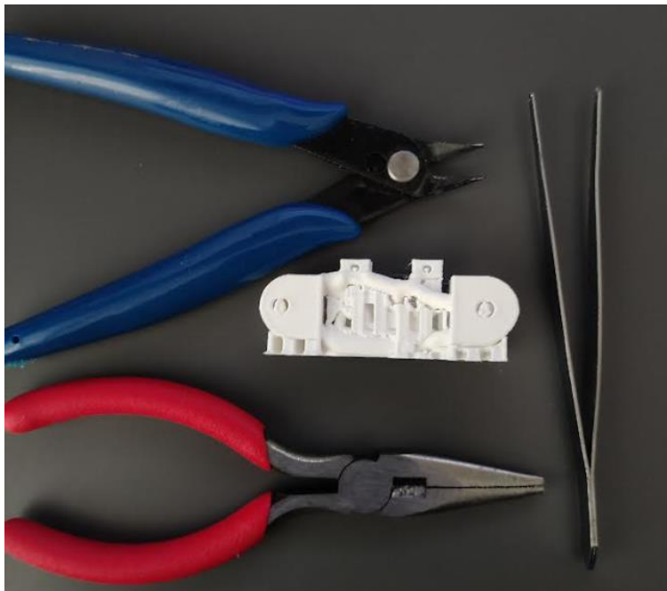
Slika 90 – Izradak te pribor za odvajanje potpornih dijelova nastalih tokom printa
