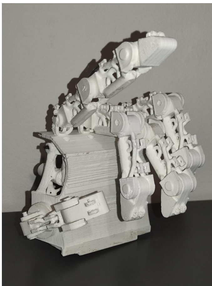
Slika 103 – Gotov prvi, funkcionalni, prototipni model bioničke šake
