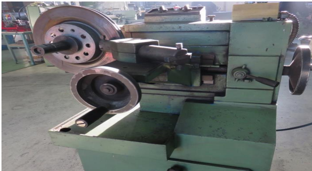
Slika 4.10 Tokarenje kočionog diska na normalnom stroju
