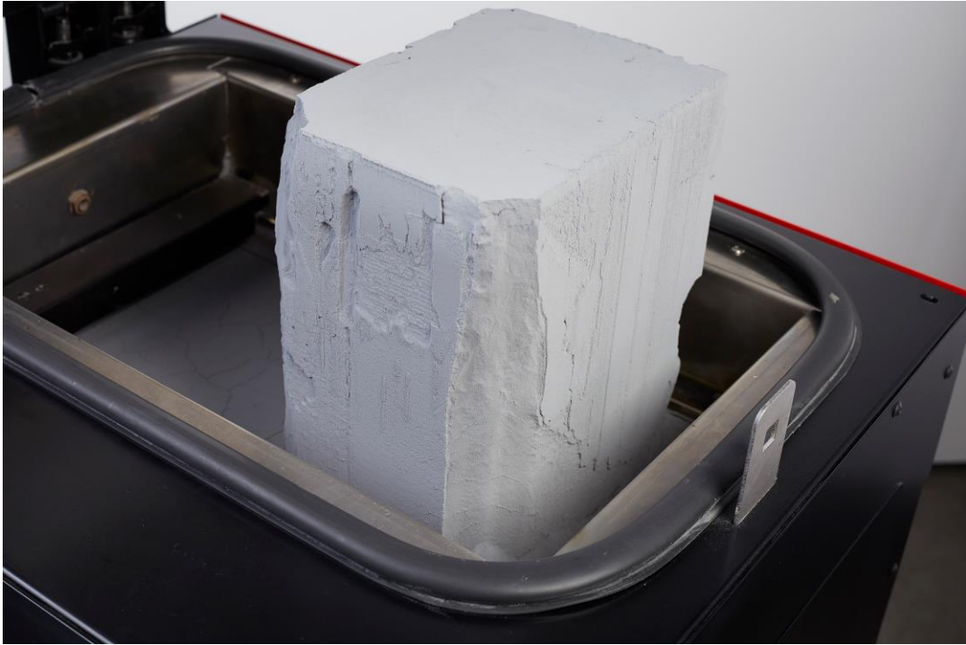
Slika 2.6 Prikaz radnog volumena nakon završetka izrade proizvoda SLS tehnologijom[8]
