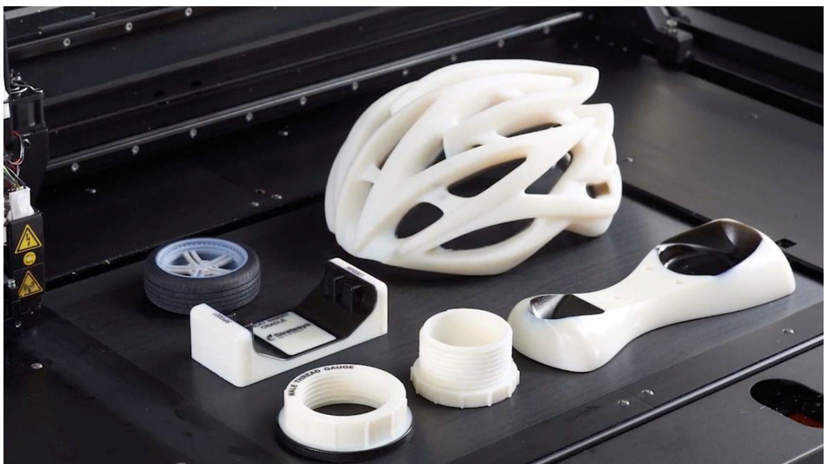
Slika 2.9 Proizvodi izrađeni PolyJet tehnologijom[9]
