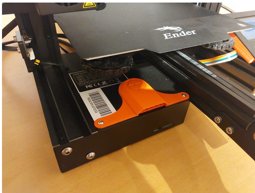
Slika 2.16 Kućište upravljačke jedinice i radna platforma [izvor: rad autora]
