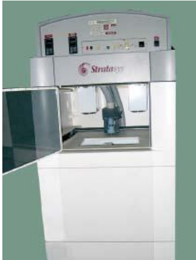
Slika 1.1 Prvi FDM 3D printer (Stratasys 3D Modleler)[1]
