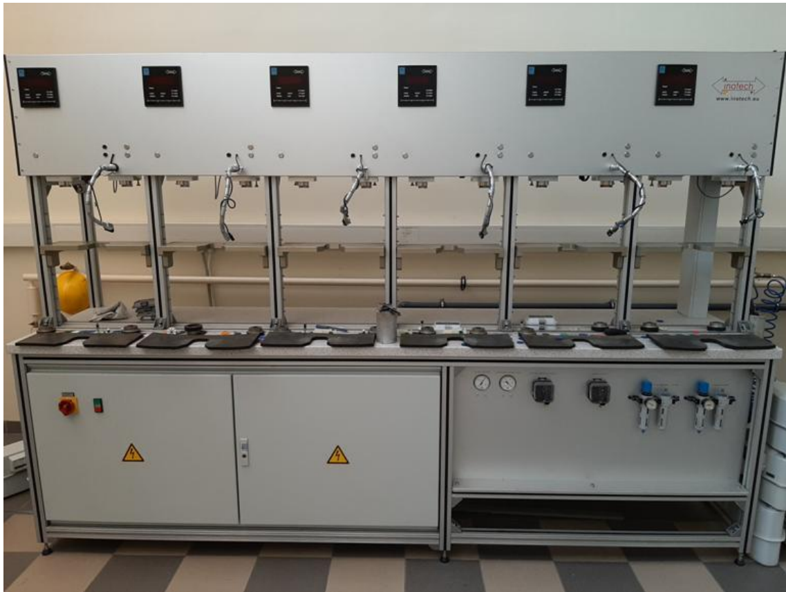
Slika 18. Ispitni uređaj s kritičnim sapnicama- Ispitna linija 1 (fotografirano 30.6.2021.)
