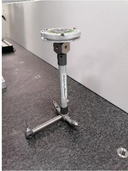
Slika 41: Taster sustav Winkel Kopfrager u praksi (fotografirano 15..07.2021.)
