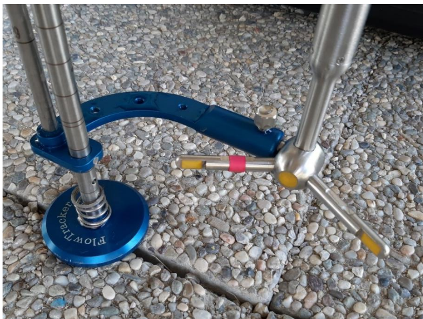
Slika 4.5. 2D sonda korištena prilikom hidroloških mjerenja
