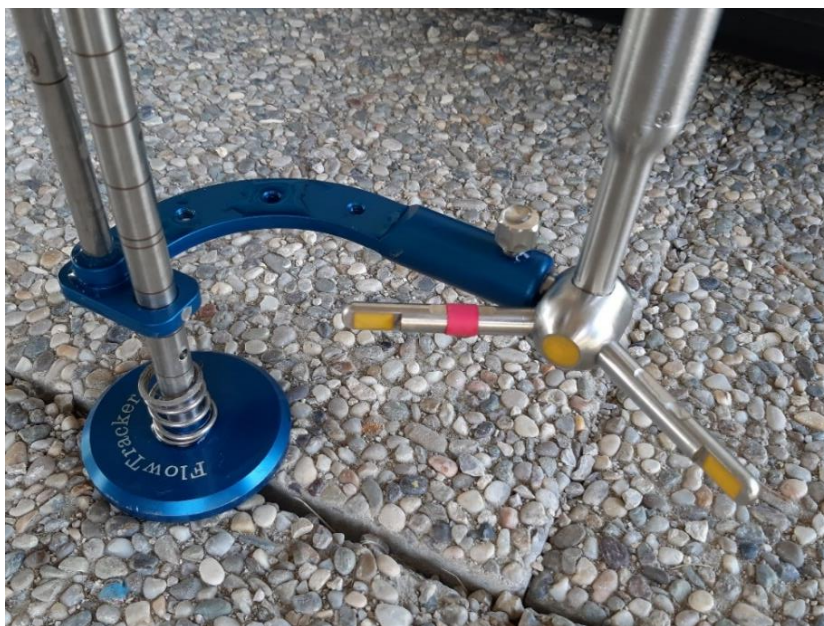
Slika 4.5. 2D sonda korištena prilikom hidroloških mjerenja
