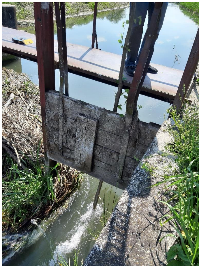
Slika 4.21. Mjerenje dubine vode kod pregrade
