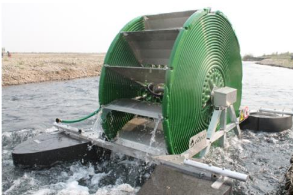
Slika 3.5. Vodenica za crpljenje vode u kanalu za navodnjavanje (tzv. pumpa) [9]
