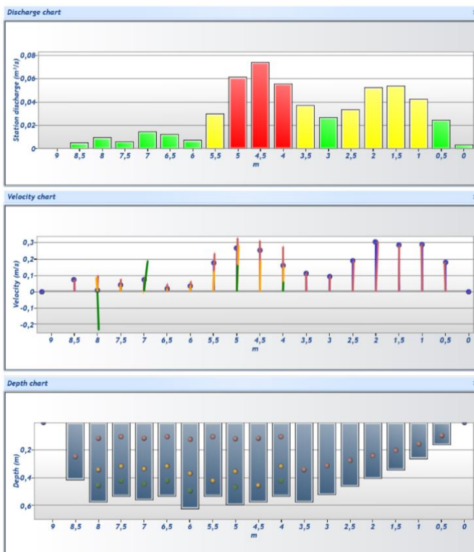
Slika 4.35. Grafički prikaz rezultata kontrolnog mjerenja 03.09.2021.
