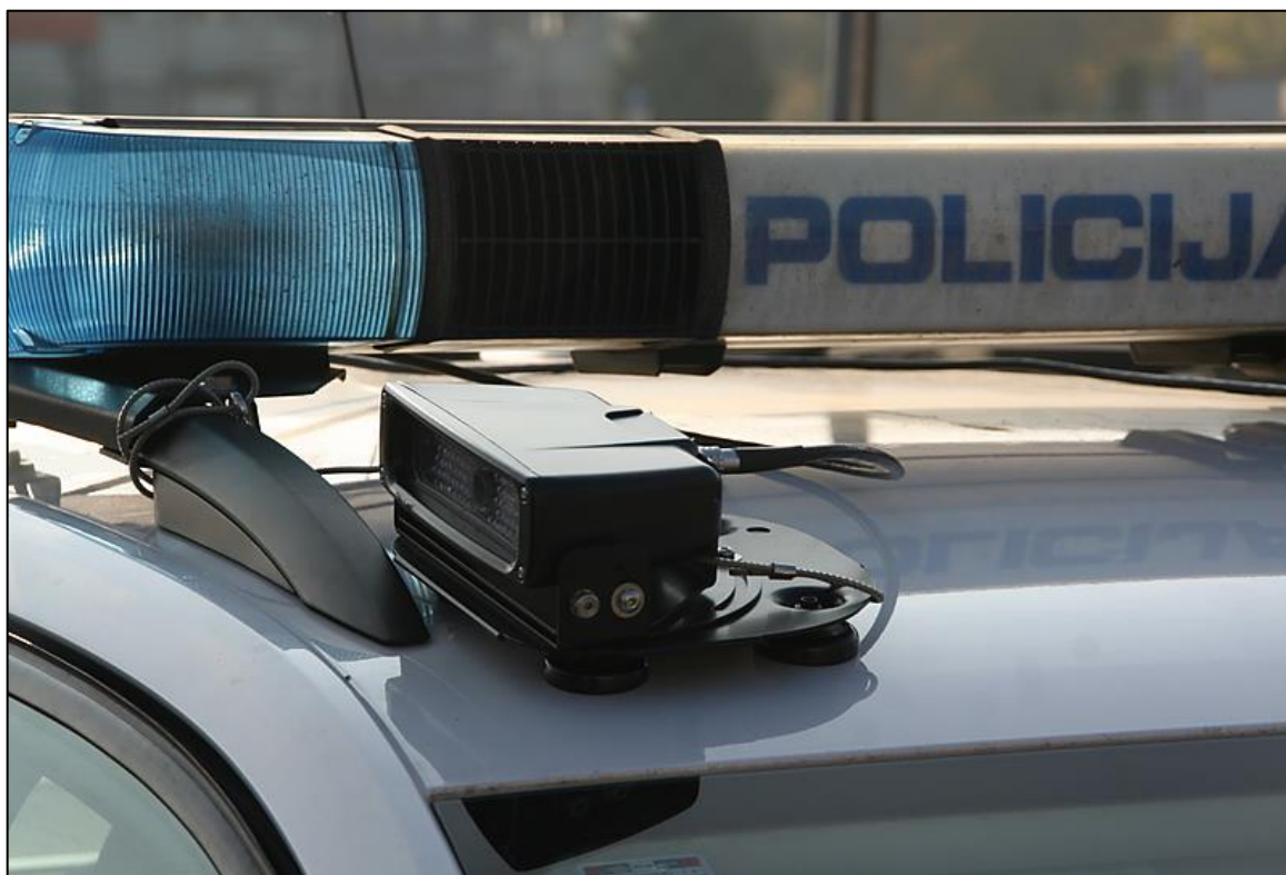
Slika 5.10. ANPR sustav na policijskom vozilu
