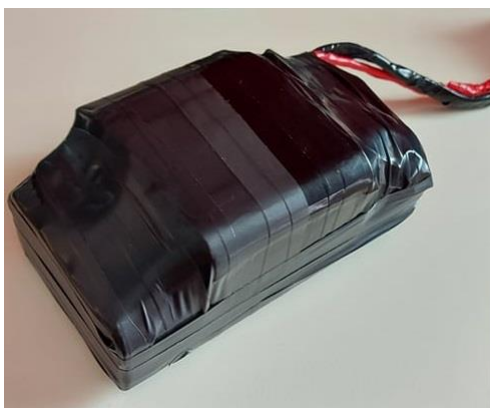
Slika 3.3: Baterija od 36 V za napajanje uzbuđenog namota
