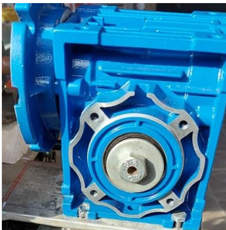
Slika 3.9: Reduktor sa omjerom redukcije 1:5
