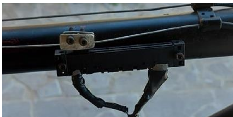
Slika 3.17: Potenciometar za regulaciju brzine vrtinje
