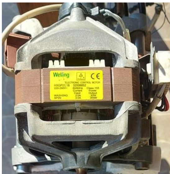
Slika 3.1: Motor korišten u projektu (motor iz perilice rublja)
