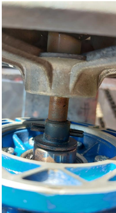
Slika 3.18: Spojnica reduktora i motora
