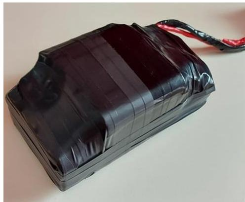
*Slika 3.3: Baterija od 36 V za napajanje uzbudnog namota*
