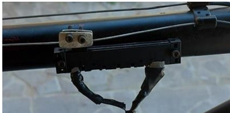
*Slika 3.17: Potenciometar za regulaciju brzine vrtnje*
