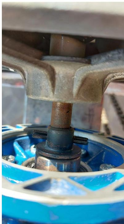
Slika 3.18: Spojnica reduktora i motora
