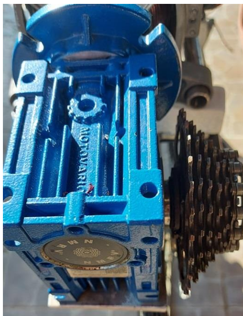
Slika 3.19: Spojnica reduktora i pogonskog lančanika
