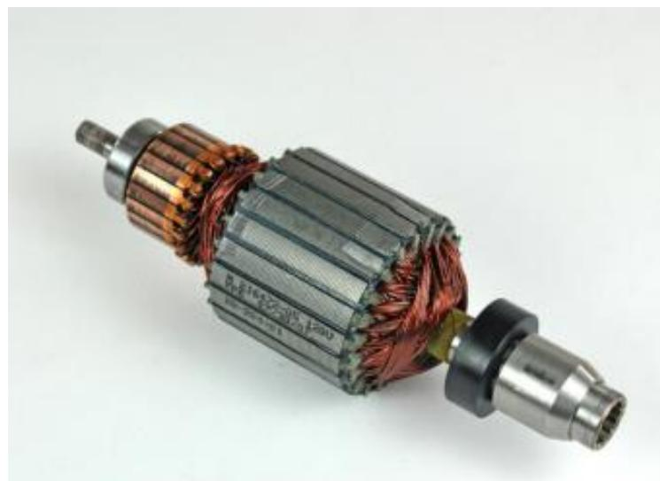
Slika 2.6: Unutrašnjost DC motora sa četkicama [9]
