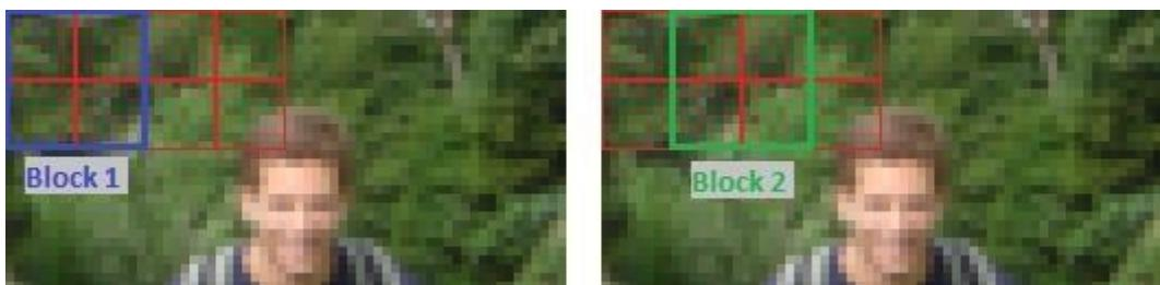
*Slika 2.7. Pomicanje normalizacijskog bloka ćelija
