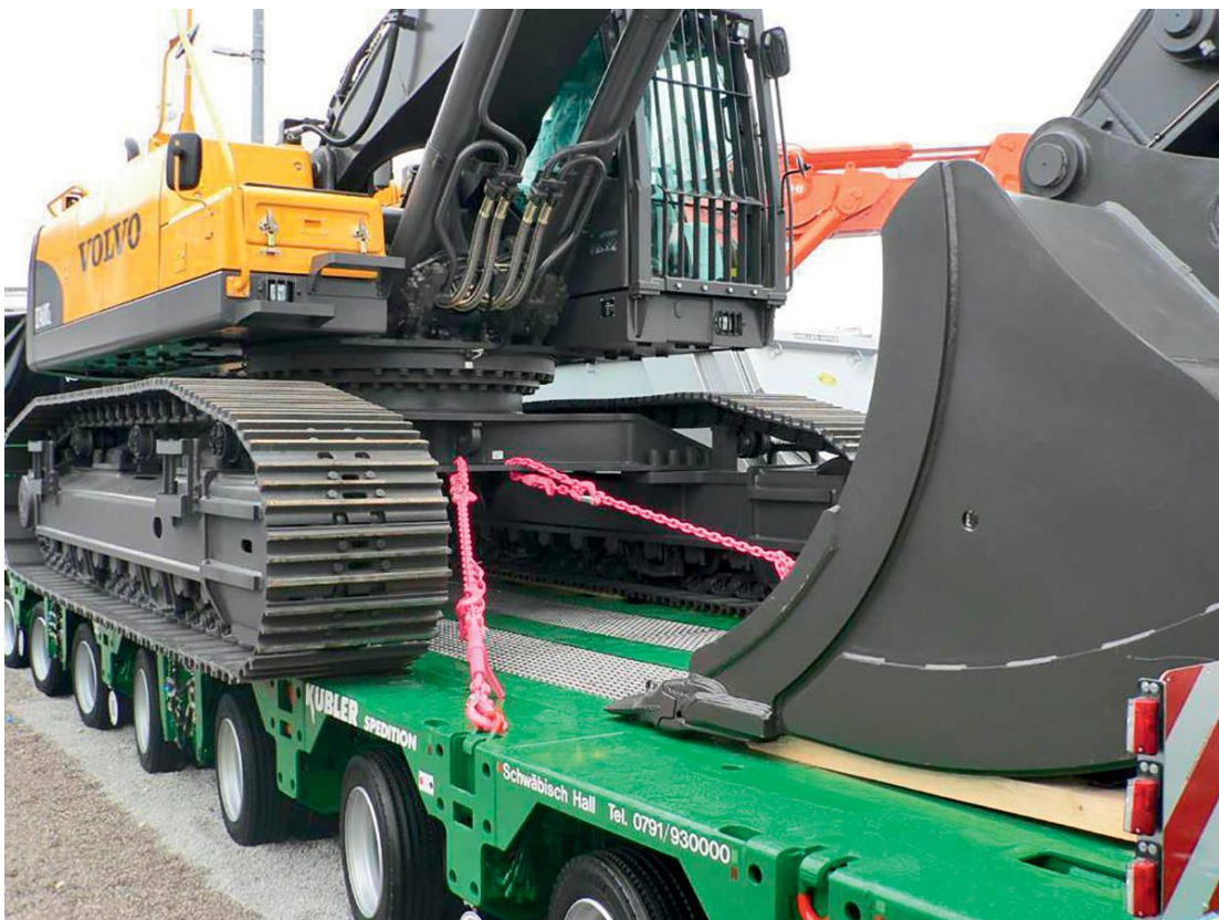
Slika 3: Primjer ispravnog dijagonalnog povezivanja stroja na labudici
