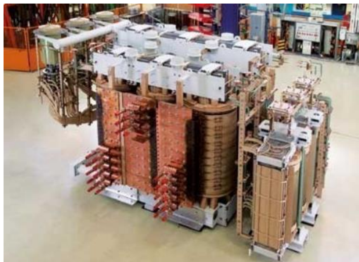
Slika 5. Korištenje bakra kod namotaja transformatora
