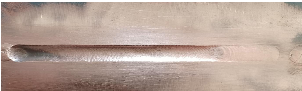
Slika 48. Lice zavara petog uzorka
