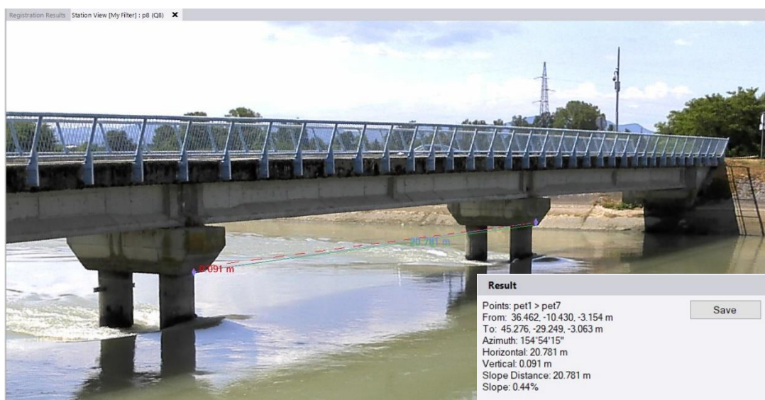
Slika 28. Uzdužni presjek mosta Družbinec iz 3D modela
