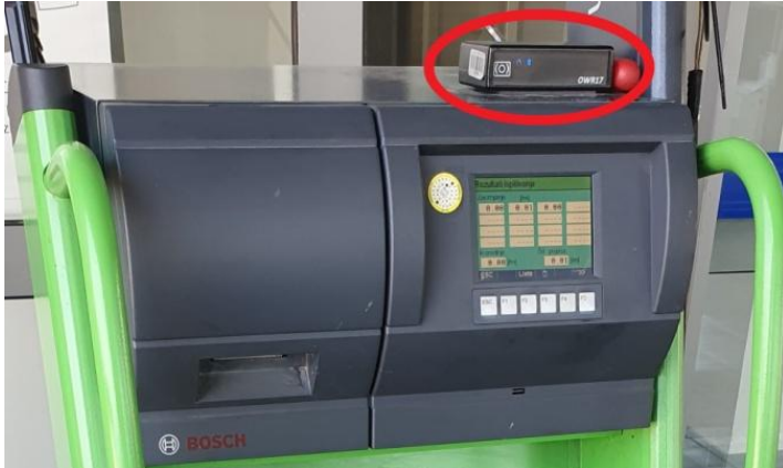
Slika 19. OWR17 uređaj implementiran na Bosch BEA 350 (fotografirano 17.06.2021.)
