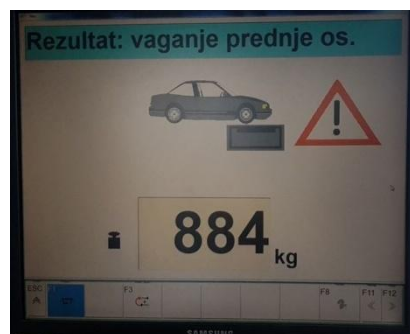
Slika 34b. Masa prednje osovine (fotografirano 17.06.2021.)
