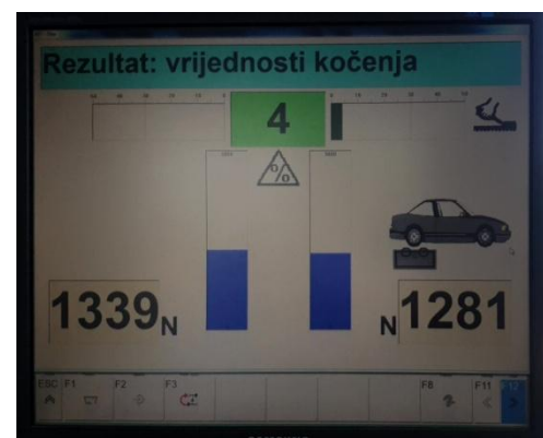
Slika 42b. Kočne sile pomoćne kočnice (fotografirano 17.06.2021.)
