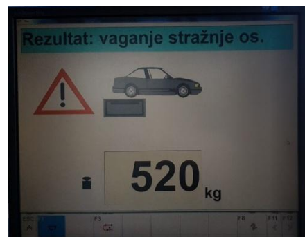
Slika 36b. Masa stražnje osovine (fotografirano 17.06.2021.)
