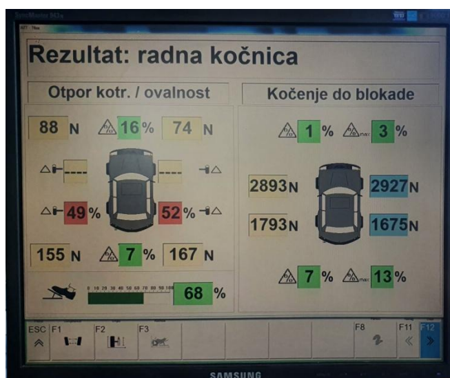
Slika 44. Rezultati ispitivanja radne kočnice (fotografirano 17.06.2021.)
