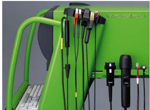
Slika 18. Mjerni senzori modula DTM [7]
