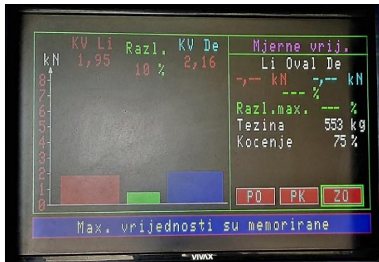
Slika 41a. Kočne sile na stražnjoj osovini (fotografirano 10.06.2021.)
