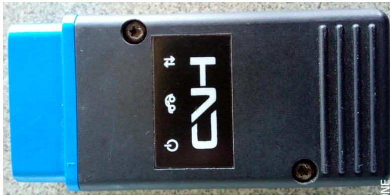
Slika 21. Uređaj za komunikaciju OBD priključnice (fotografirano 17.06.2021.)
