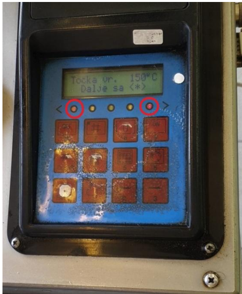
Slika 26. Neadekvatna kočna tekućina, trepere crvene diode (fotografirano 10.06.2021.)
