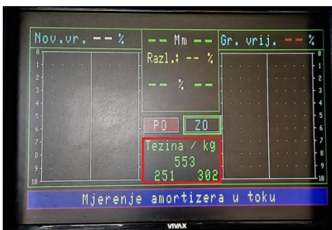
Slika 36a. Masa stražnje osovine (fotografirano 10.06.2021.)
