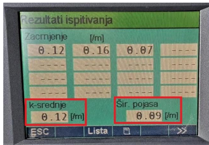
Slika 12. Srednja vrijednost koeficijenta zacrnjenja i širina pojasa zacrnjenja (fotografirano 17.06.2021.)
