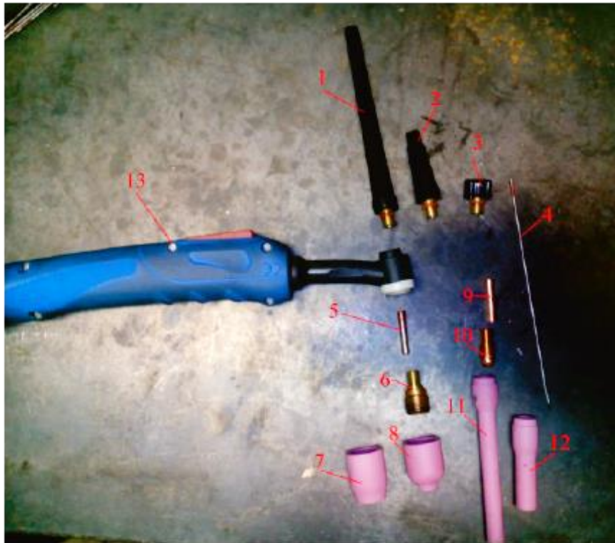
Slika 3.14. Najčešći dijelovi pištolja za TIG postupak zavarivanja [18]
