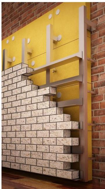
*Slika 3.6. Ventilirana fasada od opeke sa nosačima,*
