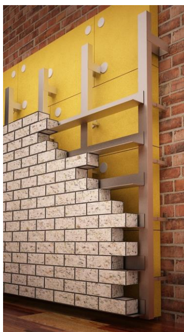
Slika 3.6. Ventilirana fasada od opeke sa nosačima, izvor https://sks-m.ru/
