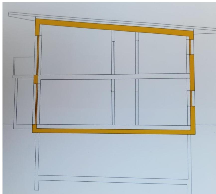
Slika 4.2.2 Prikaz pravilno izvedenog toplinskog plašta [5]
