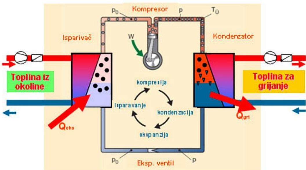
Slika 7.1.1 Princip rad toplinske crpke [36]
