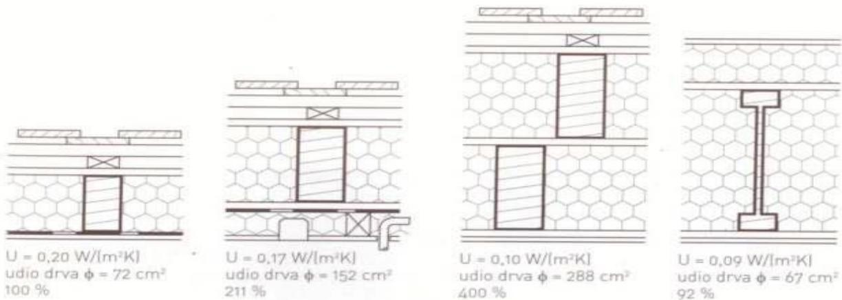
Slika 3.6.2.1 Prikaz lagane gradnje pri čemu gledajući s lijeva na desno zadnja dva primjera koriste se kod pasivne gradnje [5]
