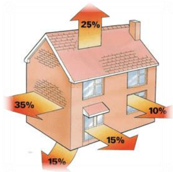
Slika 2.1 Prikaz gubitka topline pojedine dijelove građevine [4]
