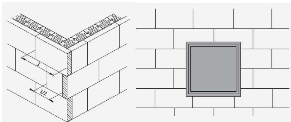
Slika 3.4.3 Shematski prikaz postavljanja izolacijskih ploča [10]
