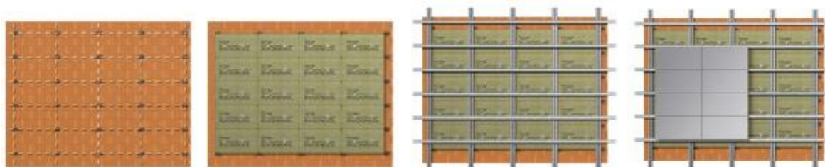
Slika 3.6.2 Izvođenje ventilirane fasade [12]
