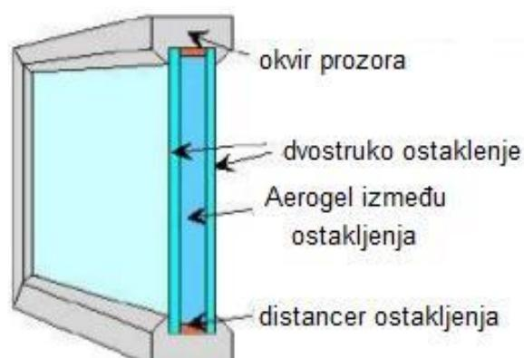
Slika 4.5.1.2 Dvostruko ostakljenje sa aerogelom [24]
