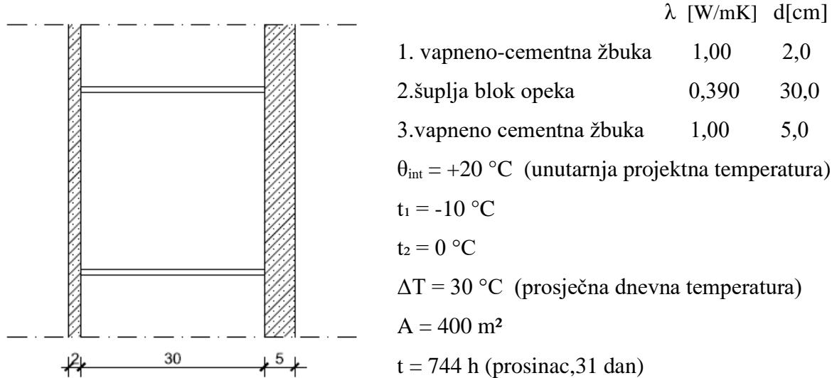
Slika 3.5.1 Presjek zida Z1-Z1 [7]
