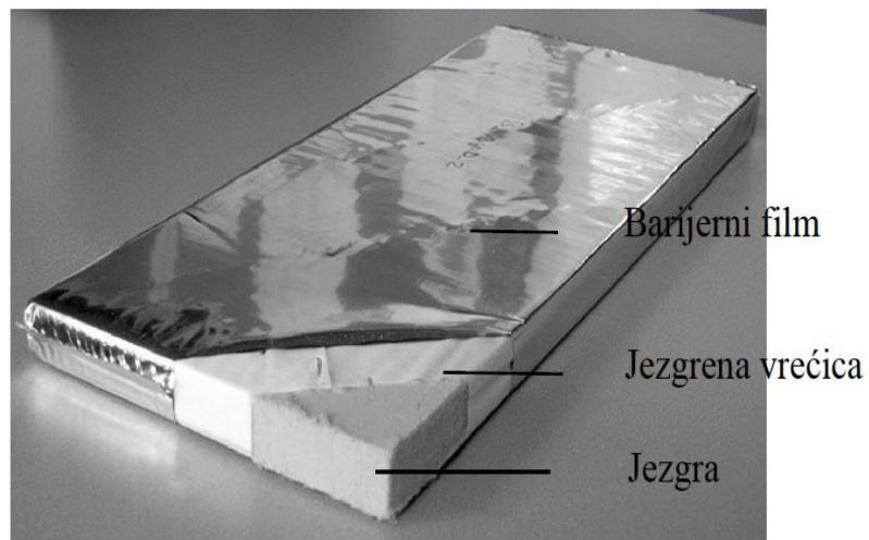
Slika 4.5.3.1 Vakuum izolacijski panel [24]
