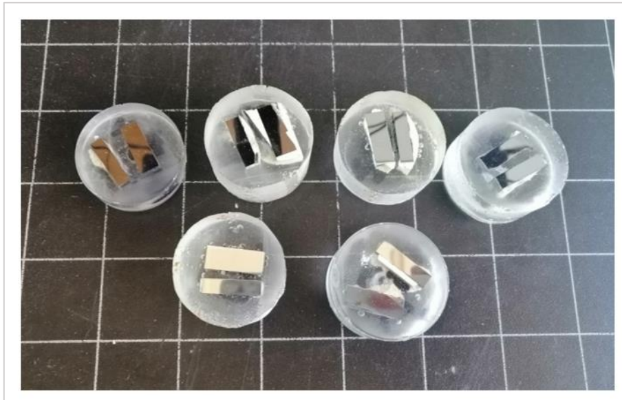
Slika 29. Uzorci nakon metalografske pripreme.
