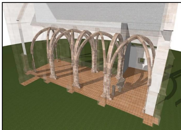
Slika 58. Vizualizacija gotičkih stupova, kapitela i svodova
