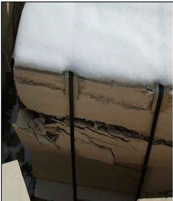
Slika 49. Detalj oštećenja lokalnog kamena (1)
