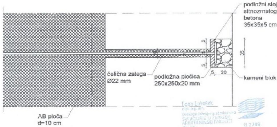
Kroz AB ploču debljine 10 cm prolaze čelične zatege Ø22mm na pozicijama kako je prikazano na tlocrtu. Zatege se sidre na čelične podložne pločice dimenzije 250x250x20 mm koje su postavljene na podložni sloj sitnozrnatog betona debljine 5 cm koji je upušten u zid cca. 20 cm. Svi čelični dijelovi (podložna pločica i matica) zaštićuju se barem 3 cm debelim slojem 'Masterflow 928', a na kraju se sve zatvara kamenim blokom odgovarajućih dimenzija.
