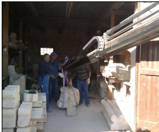
Slika 37. Skladištenje stupova i kapitela
