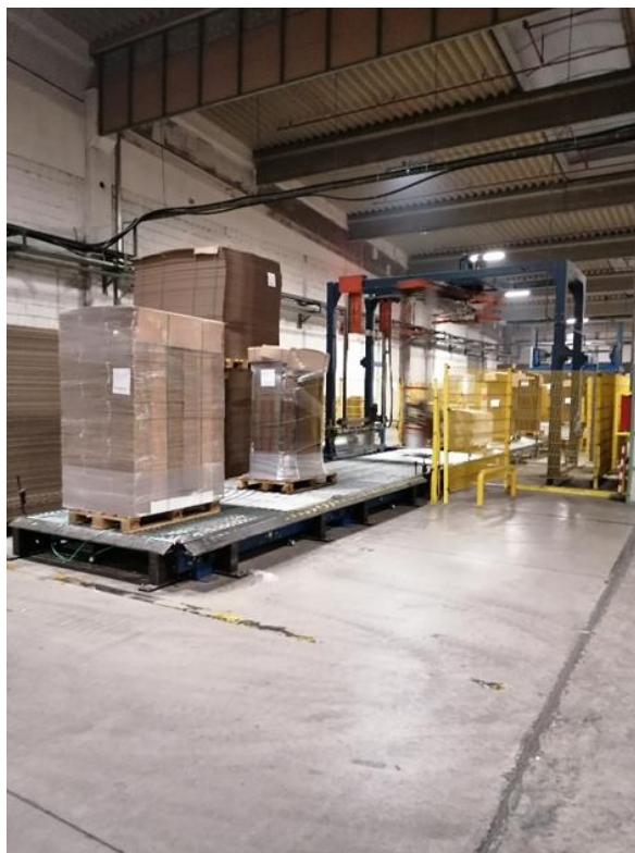
Slika 8: Strojno omatanje folijom
