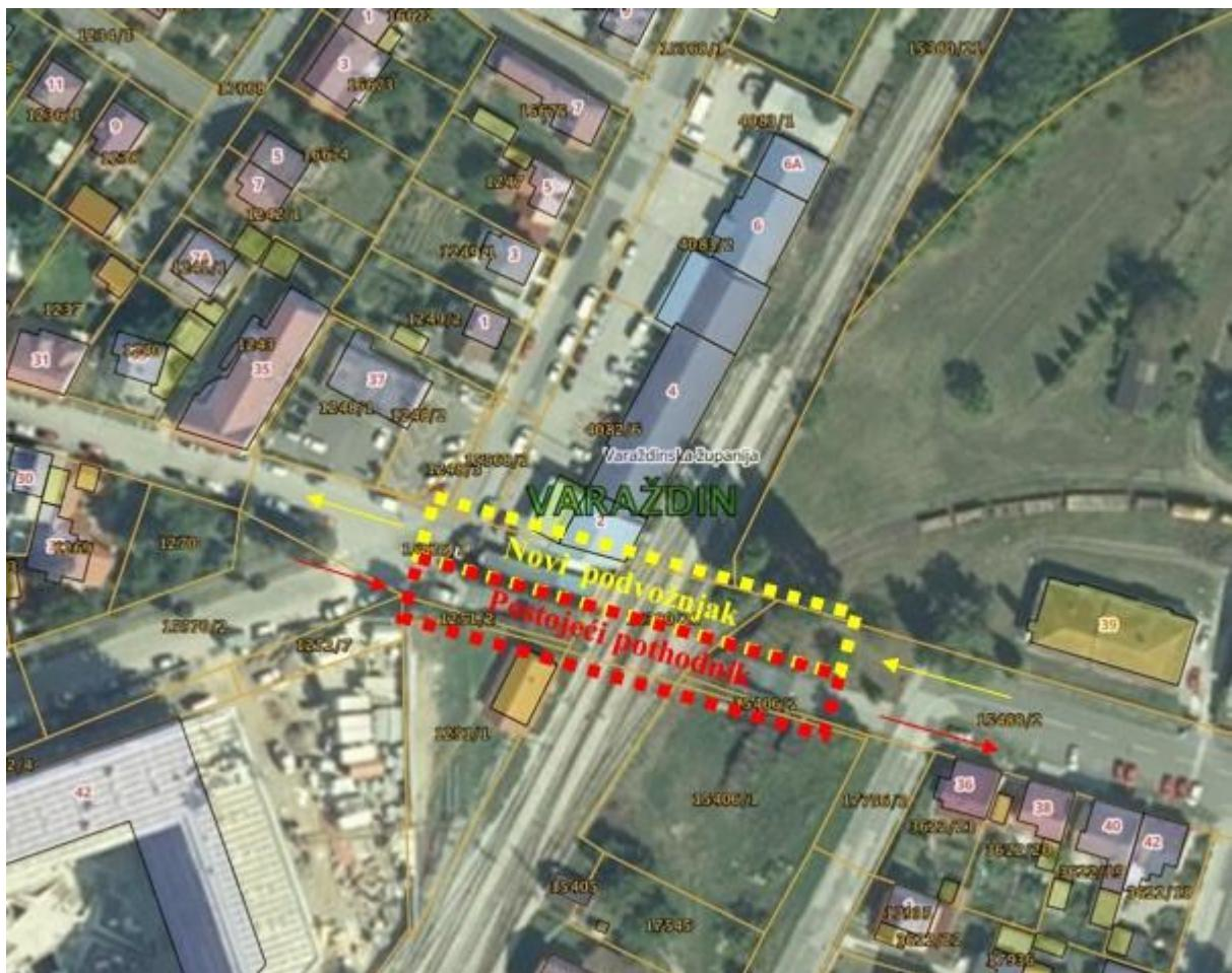
pješačkog dijela a ujedno bi se izvela i zaštitna ograda zbog što veće zaštite pješaka. Izvedba novog podvožnjaka ispod željezničke pruge provodila bi se bez zatvaranja željezničkog pružnog prometa, odnosno da se promet željezničkom prugom odvija nesmetano ili da se eventualno odvijali manji zahvati unutar spomenutog pojasa prometa ali u vrijeme kad se ne odvija promet željezničkom prugom [7].
