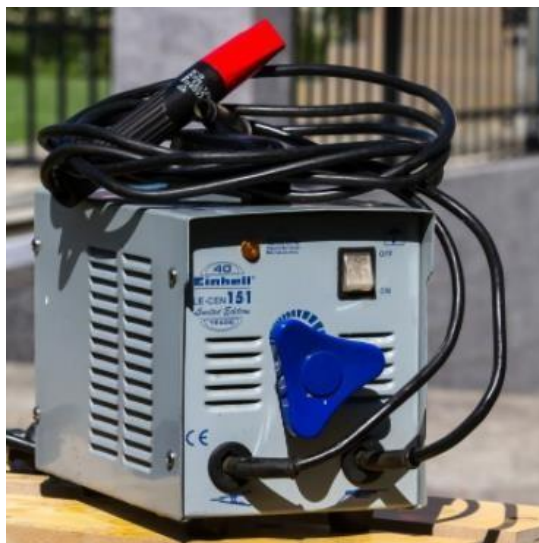
Slika 5. Einzel 151 aparat za REL postupak zavarivanja [8]
