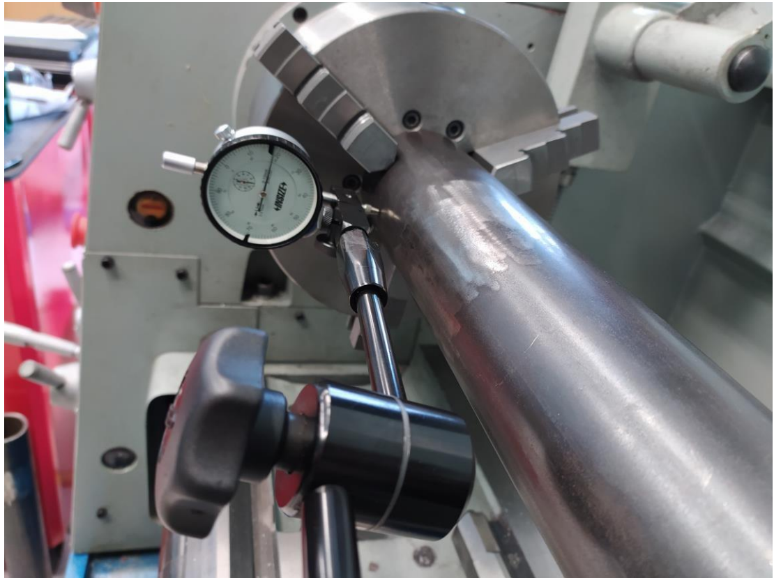
Slika 31. Kružnost cijevi prije predgrijavanja i navarivanja [17]
