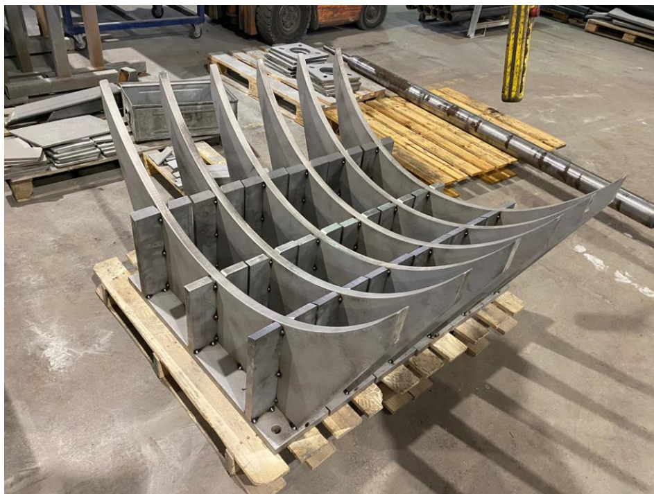
Slika 4-5 Sedlo zavareno kutnim zavarima
