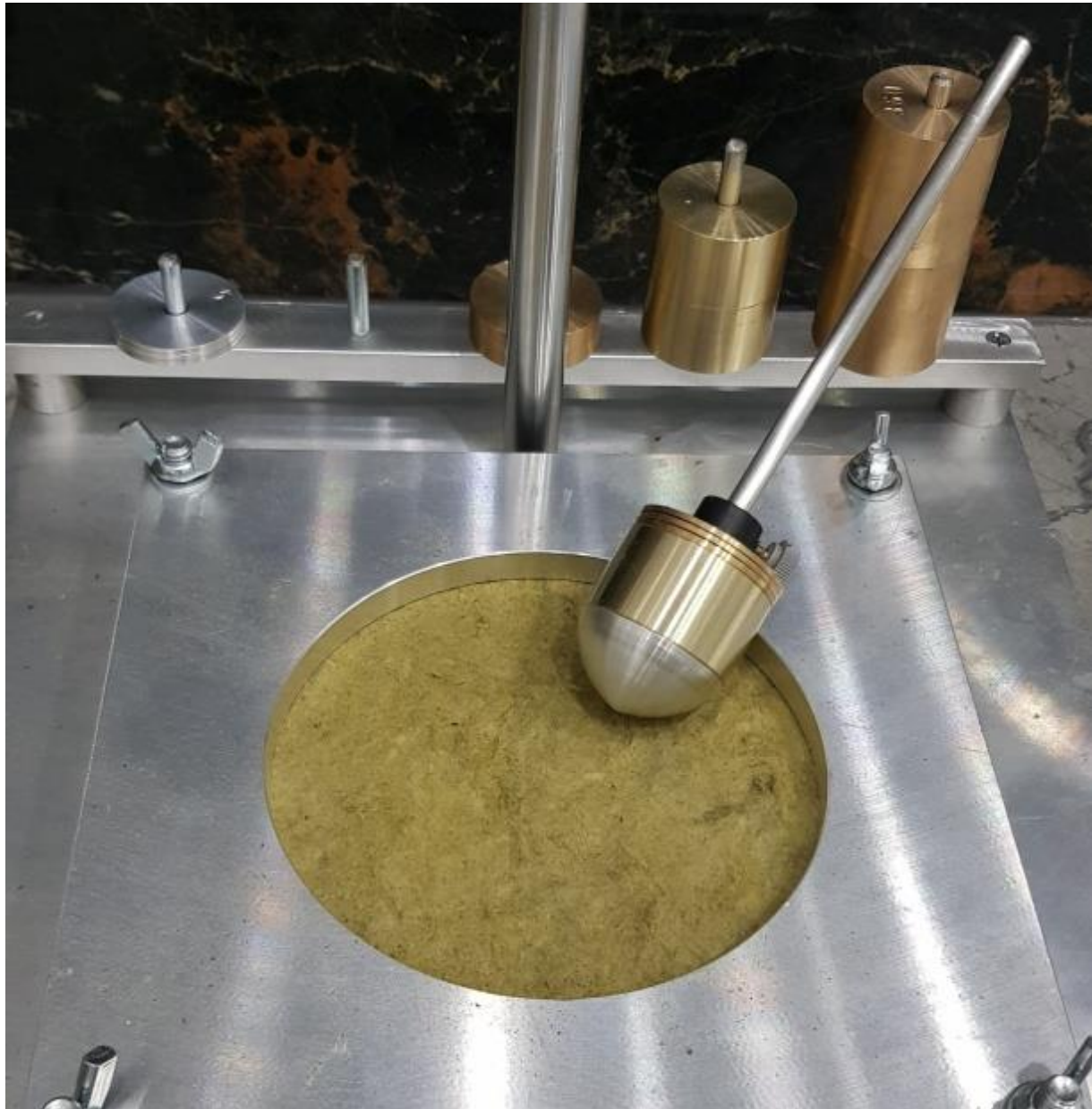
Slika 40. Uteg ne probija uzorak
