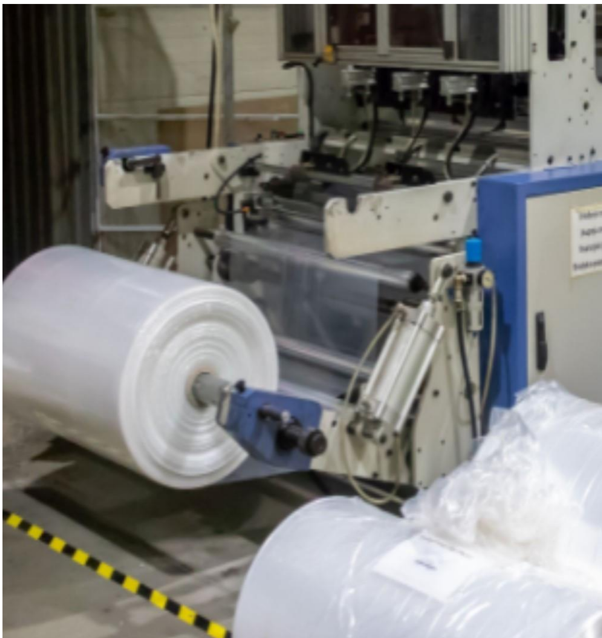
Slika 10. Izrada plastične folije [10]
