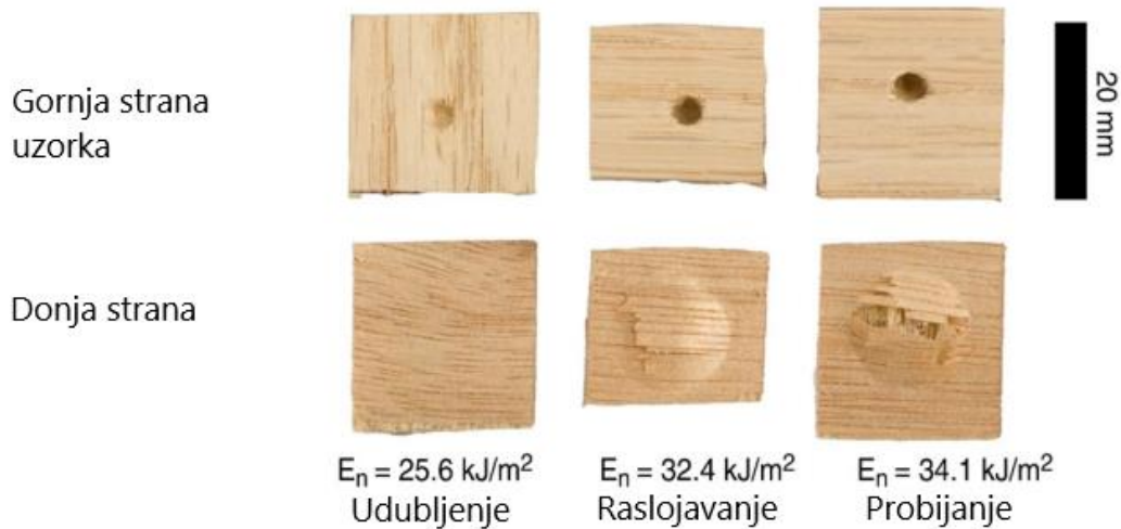
Slika 5. Rezultati testiranja Hrastove šperploče debljine 5.44 mm [6]
