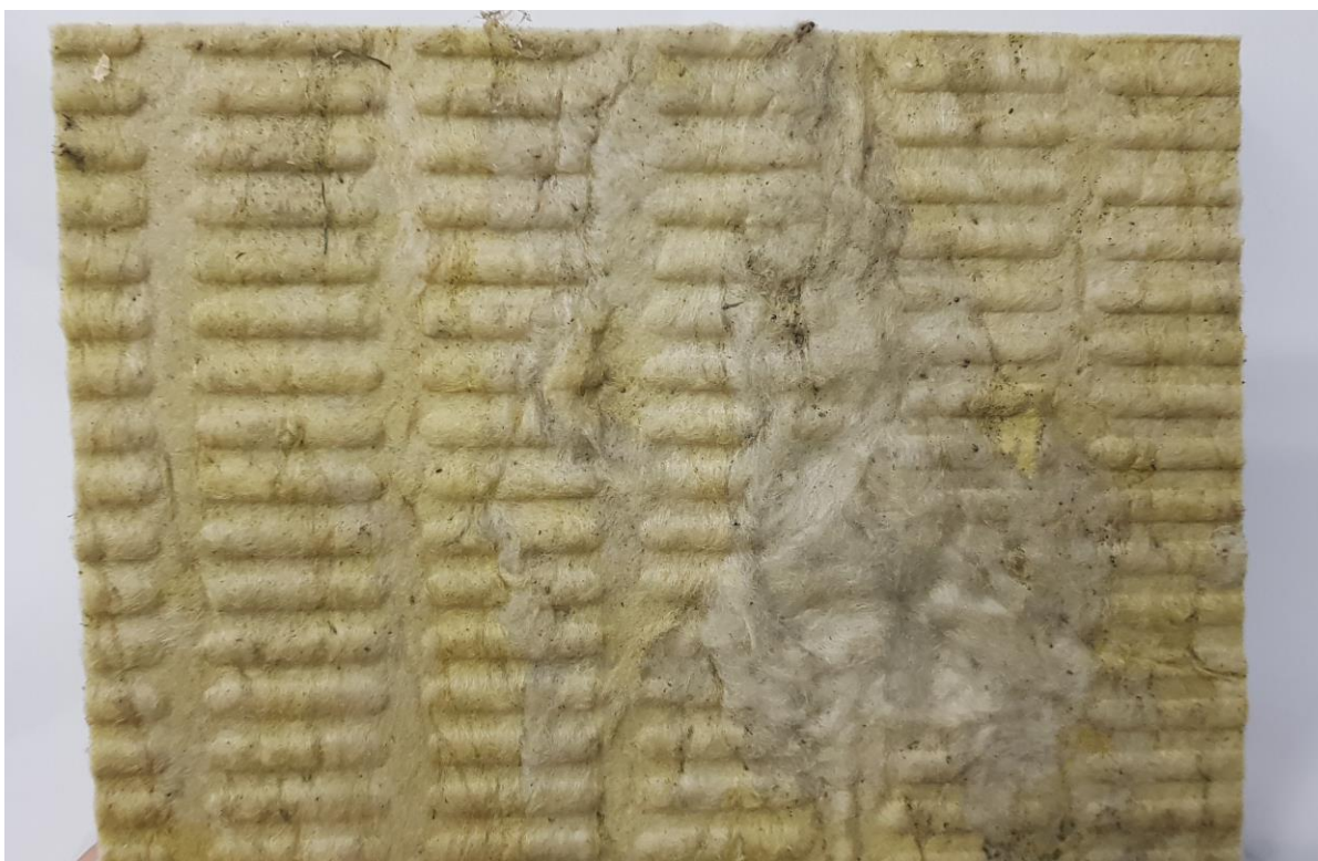
Slika 44. Nepravilnosti u materijalu
