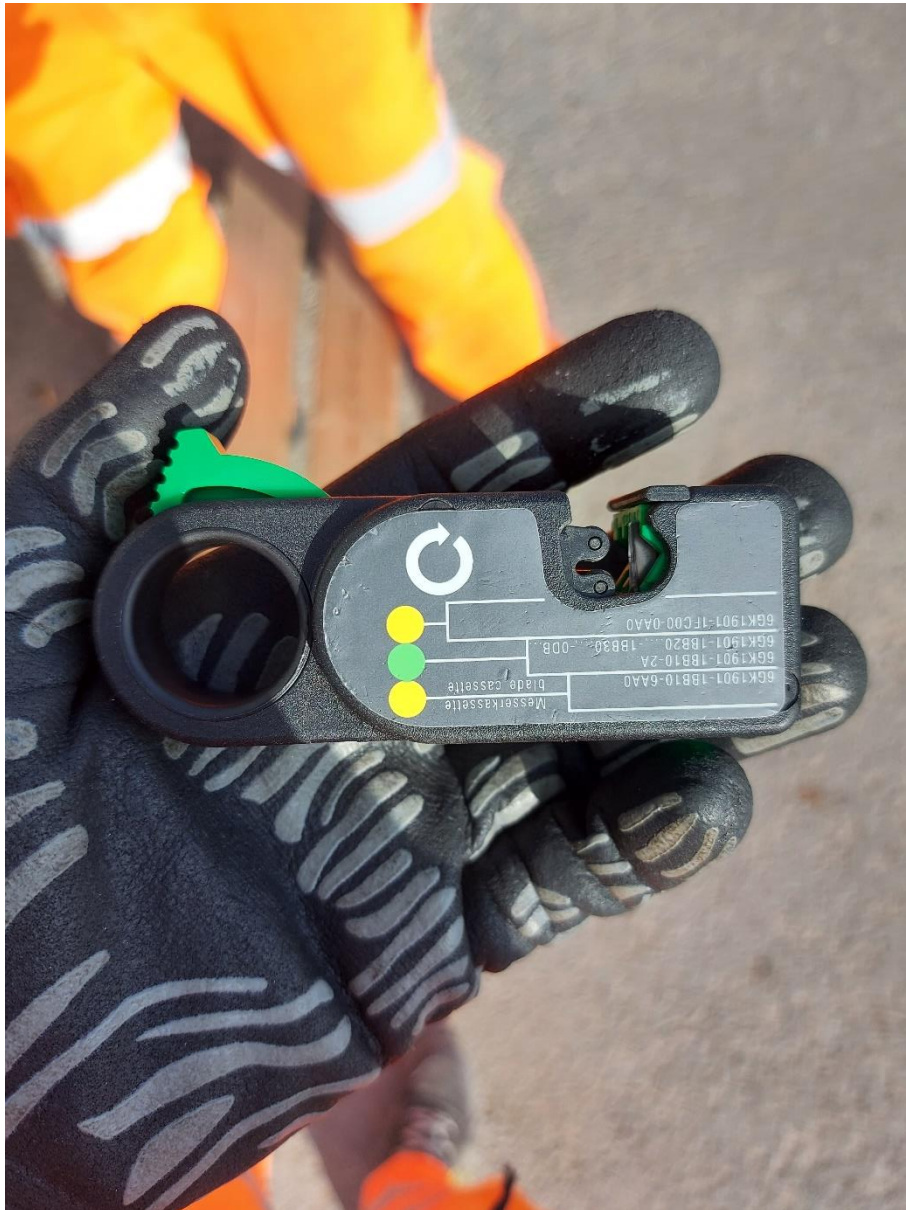
Slika 6.14 Posebni alat za skidanje izolacije profinet kablova
