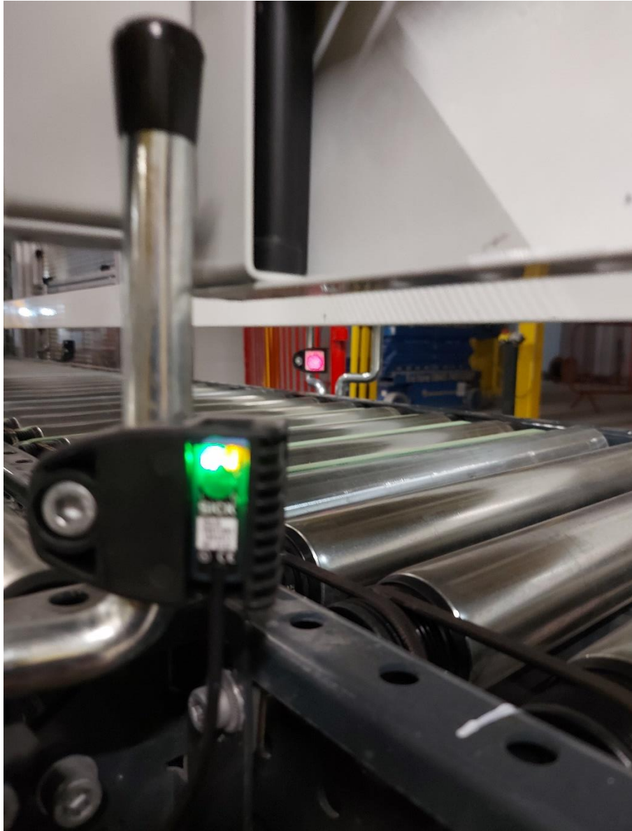
Slika 7.1 Laserski senzor i reflektirajuća traka na L profilu, te kako se laser reflektira sa reflektirajuće trake natrag na senzor
