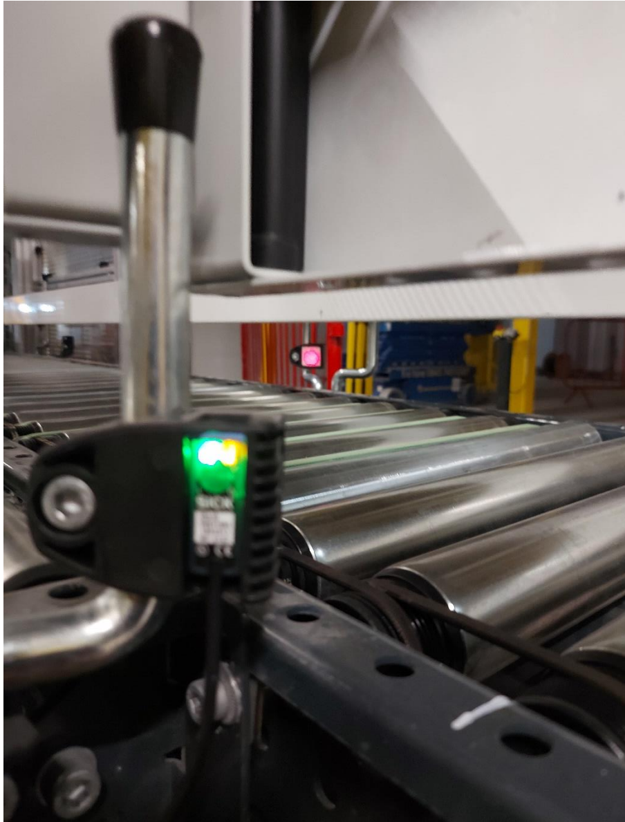
Slika 9.8 Senzor daje povratni signal sa reflektirajuće trake
