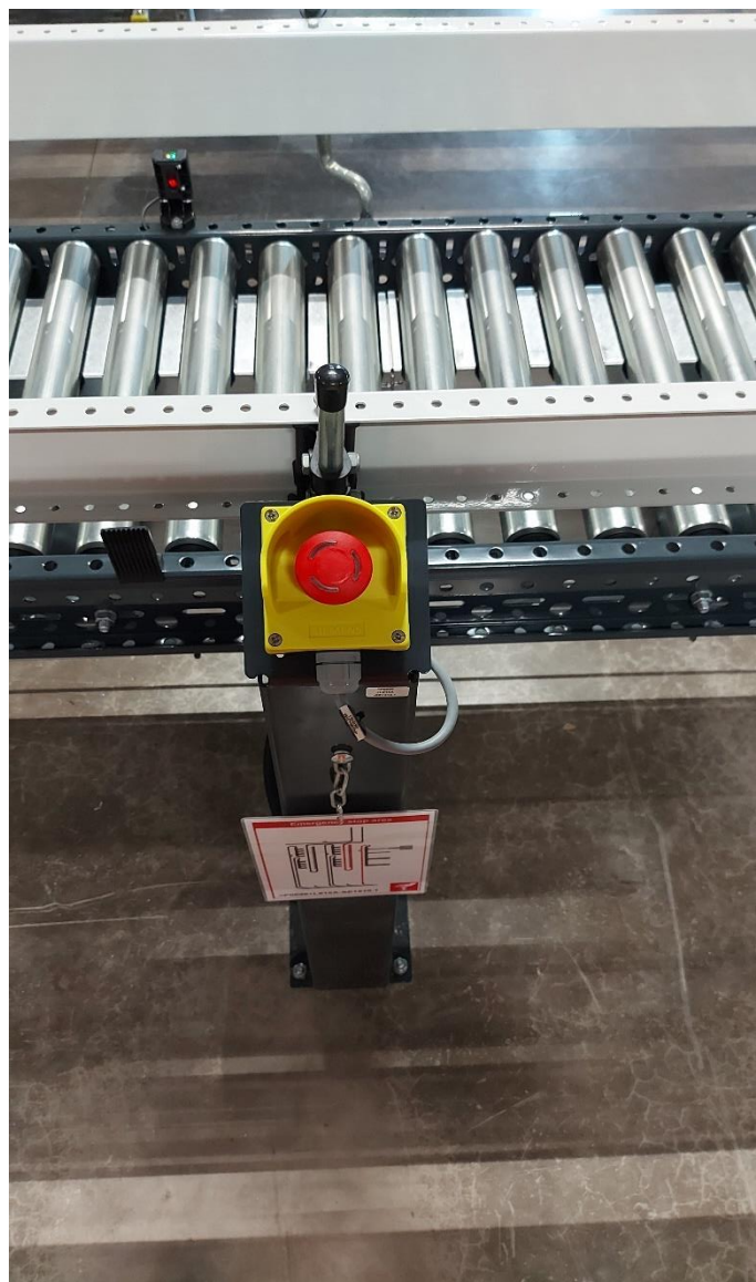
Slika 9.11. Tip tipke u slučaju opasnosti na stalku, također sadrži karticu koja prikazuje što sve zaustavlja u slučaju pritiska tipke (cijela linija u ovom slučaju)
