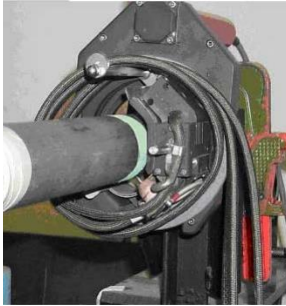
Slika 27. Orbitalno A –TIG zavarivanje cijevi [11]
