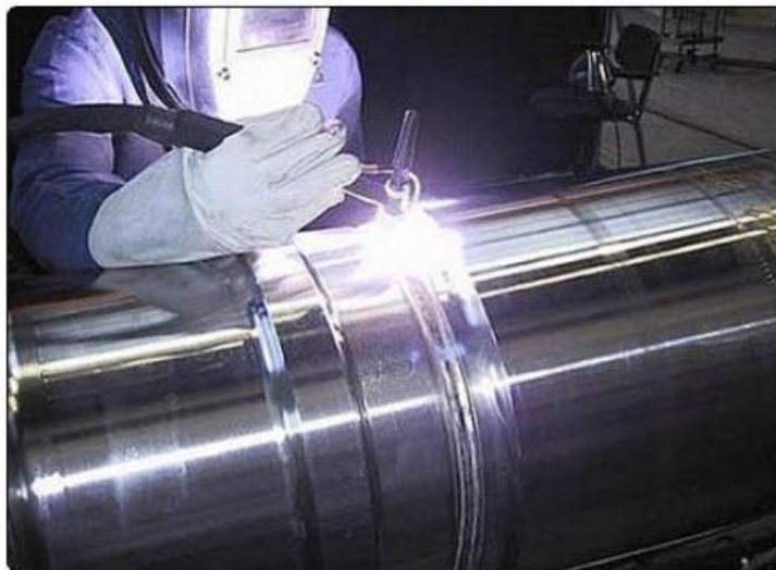
Slika 6. Zavarivanje cijevi ručnim TIG postupkom [15]
