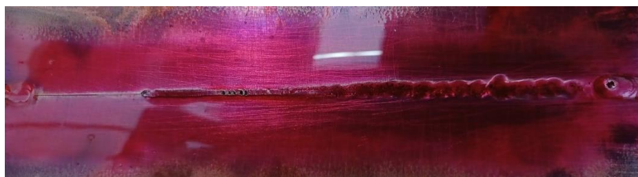
Slika 39. Slike zavara nakon nanošenja penetranta
