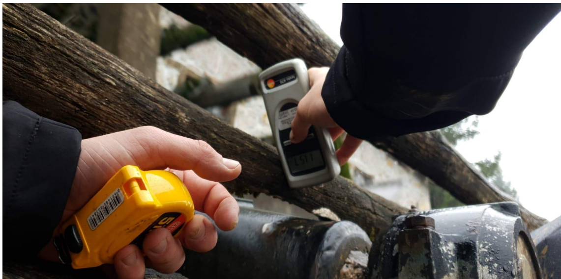
Slika 35. Mjerenja broja okretaja pomoću uređaja Tachometer [3]
