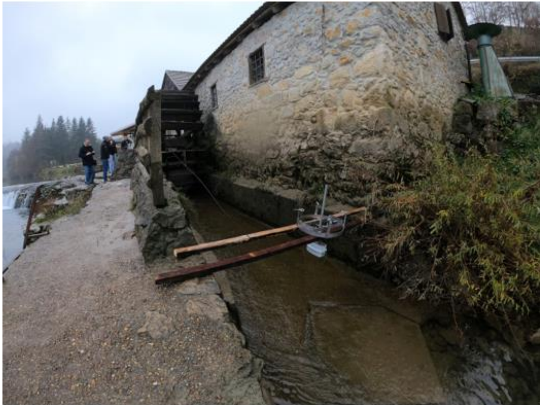
Slika 32. Postavljanje SQ-R Flow Meter [3]
