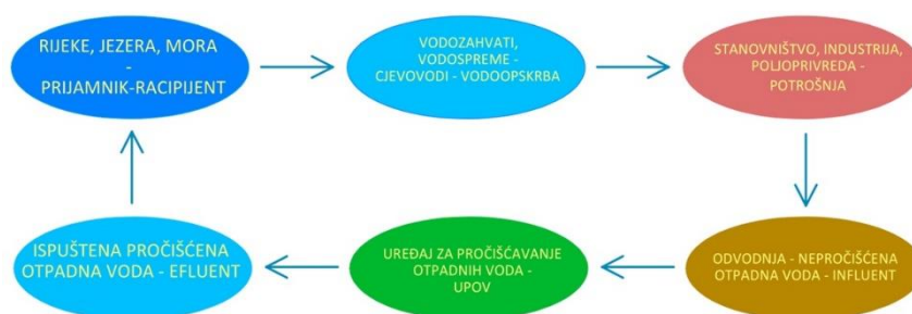
Slika 1. Crpljenje i ispuštanje vode
