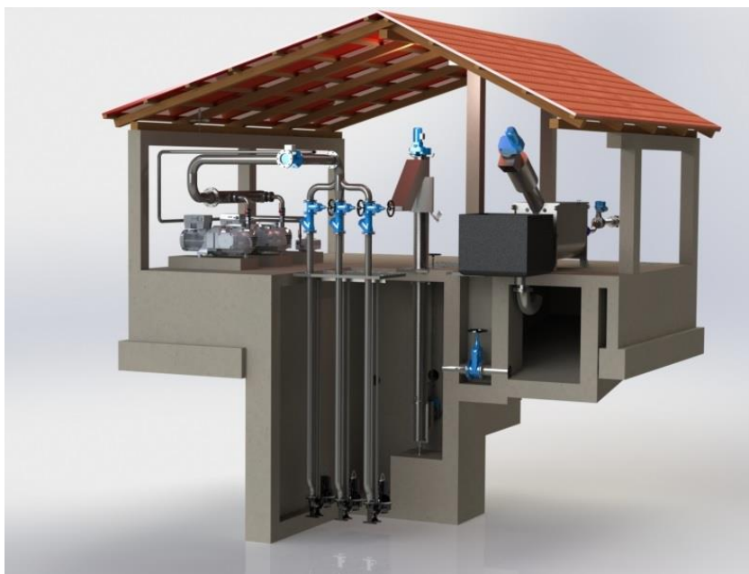
Slika 14: Prikaz 3D modela pogonske zgrade [7]
