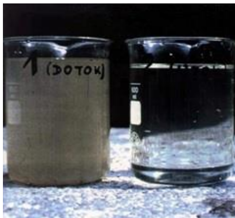
Slika 13: Voda na ulazu (lijevo) i izlazu (desno) iz uređaja [11]
