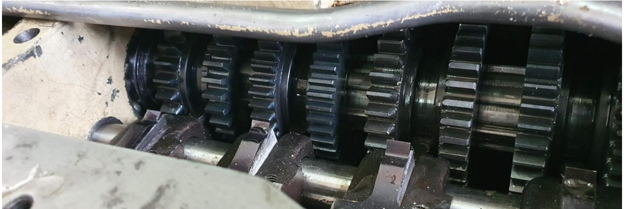
Slika 9.1 Novi zupčanici montirani u stroju
