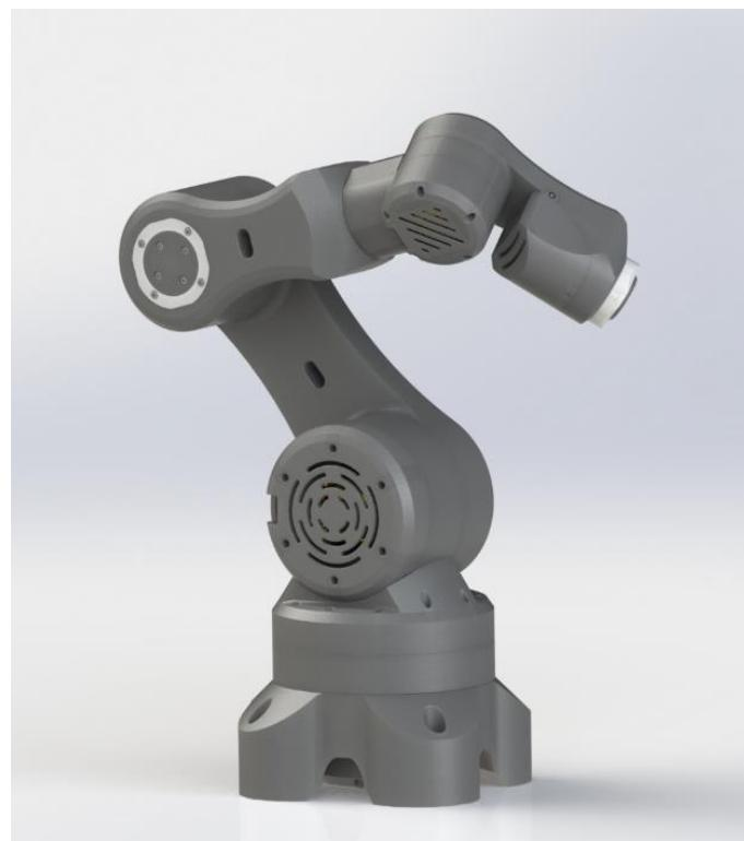
Slika 26. Renderirani model robotske ruke (iz vlastite arhive: 15.09.2021. 21:58)
