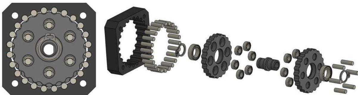
Slika 21. Model cikloidnog reduktora šestog zgloba robotske ruke
