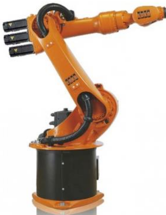
Slika 12. Smještaj aktuatora zglobova 4,5 i 6 iza zgloba 3 u cilju optimirane distribucije mase odnosno povećanja nosivosti na primjeru robotske ruke Kuka KR 16KS [7]
