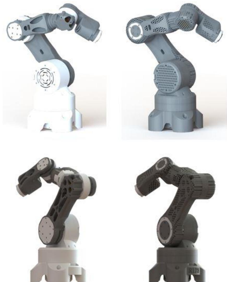
Slika 44. Model robotske ruke nakon optimizacije (lijevo) i nakon finalnog redizajna (desno)
