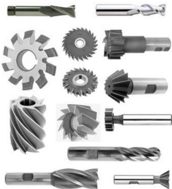
Slika 3.3 Glodala izrađena iz jednog komada [2]
