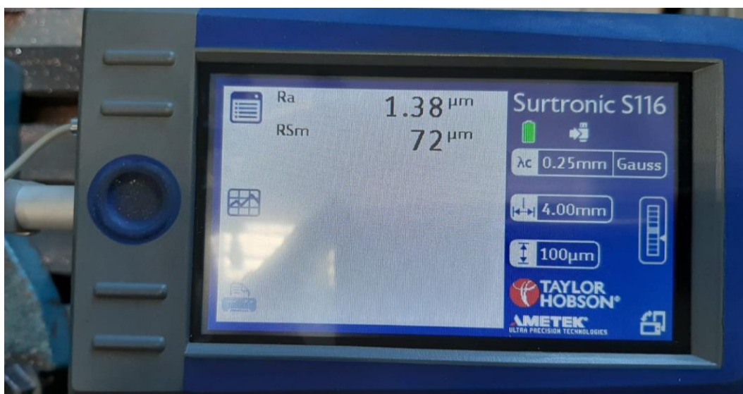
Slika 4.11 Uređaj AMETEK Taylor Hobson Surtronic S-100 Series
