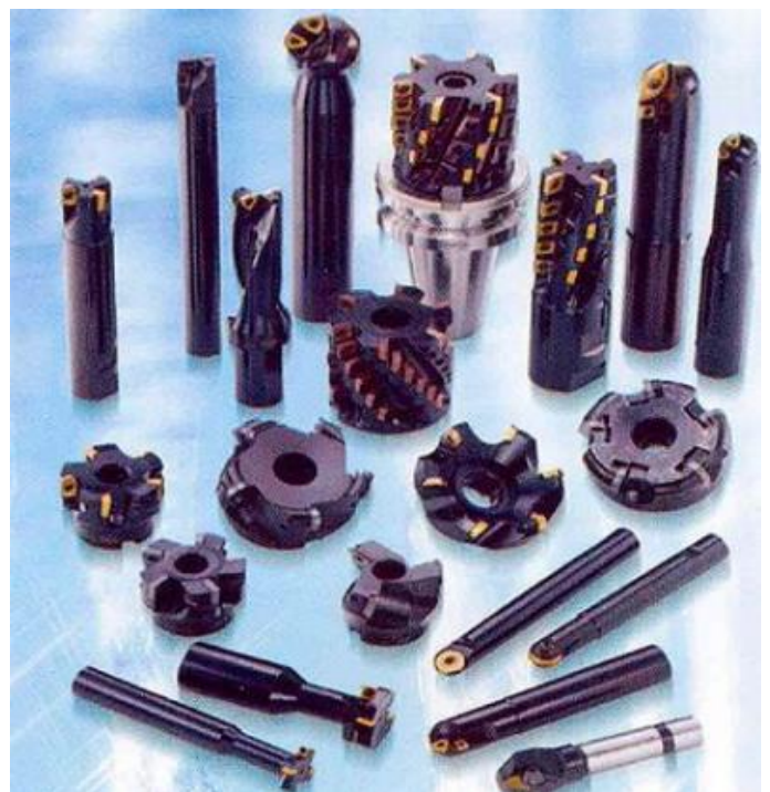
Slika 3.4 Glodala s umetnutim reznim oštricama [2]
