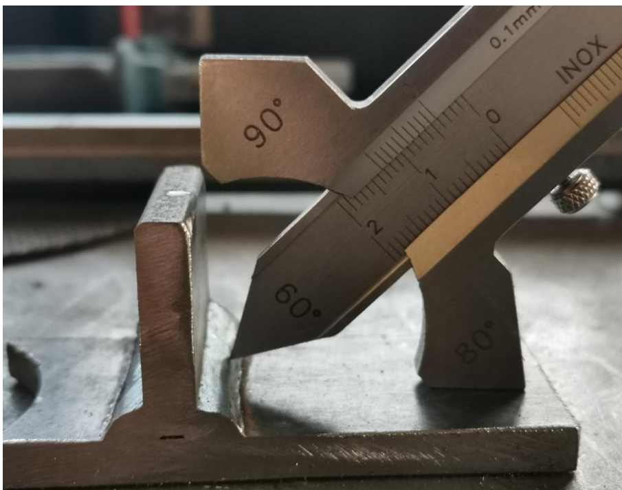
Slika 4.25. Mjerenje debljine zavara
