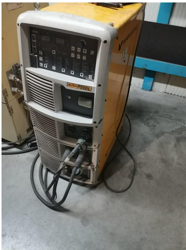
Slika 4.4. izvor struje WB-P500L
