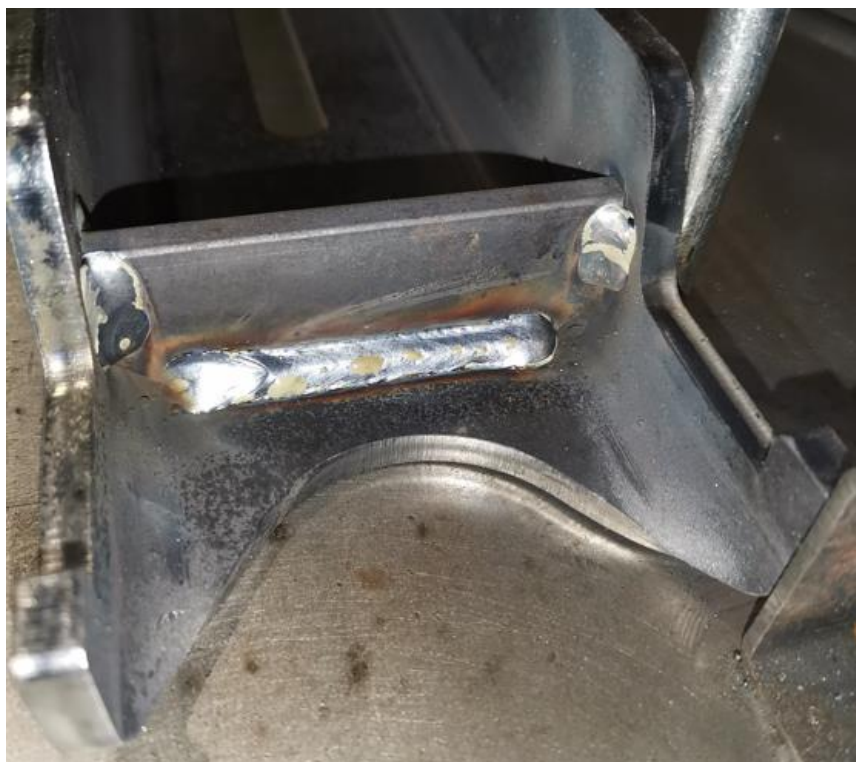
Slika 4.11. Zavarena prednja pločica
