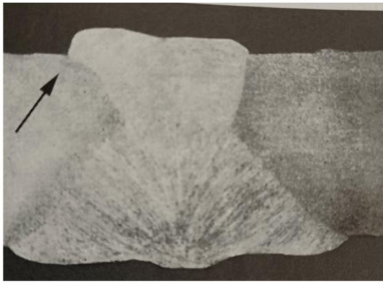
Slika 3.13. Pogreške oblika zavora – oštar prijelaz i preklop [29]
