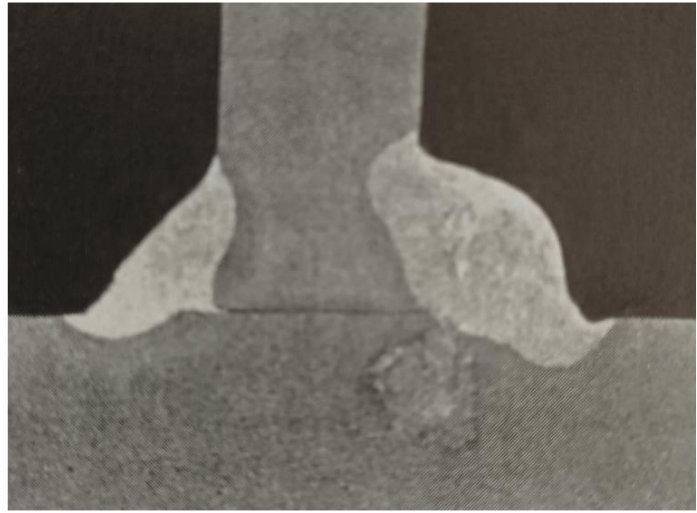
Slika 3.12. Pogreške oblika zavora – ugorine i ispupčenost kutnog zavora [29]
