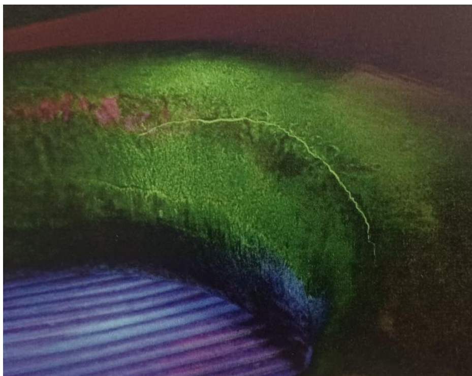
Slika 2.11. Magnetska indikacija otkrivena fluorescentnom tehnikom [17]
