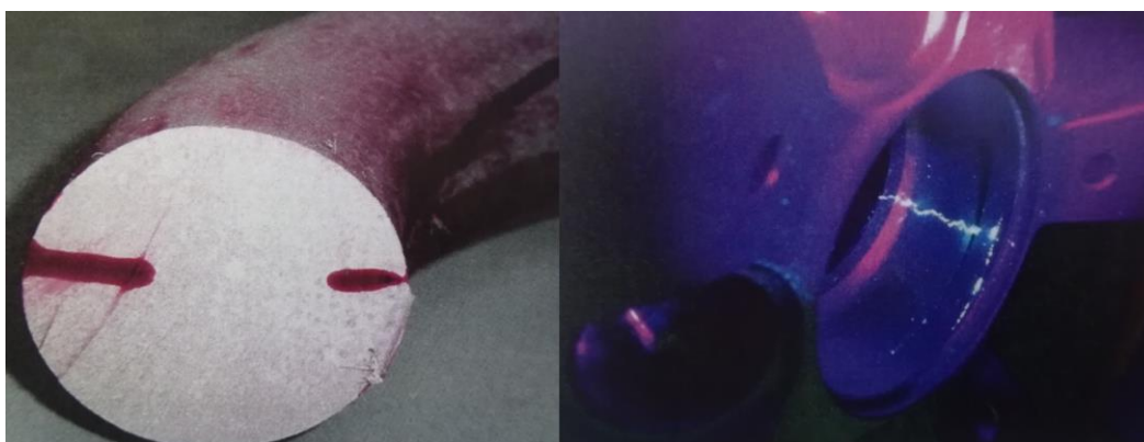
Slika 2.5. Obojani crveni penetrant (lijevo) i fluorescentni penetrant (desno) [15]
