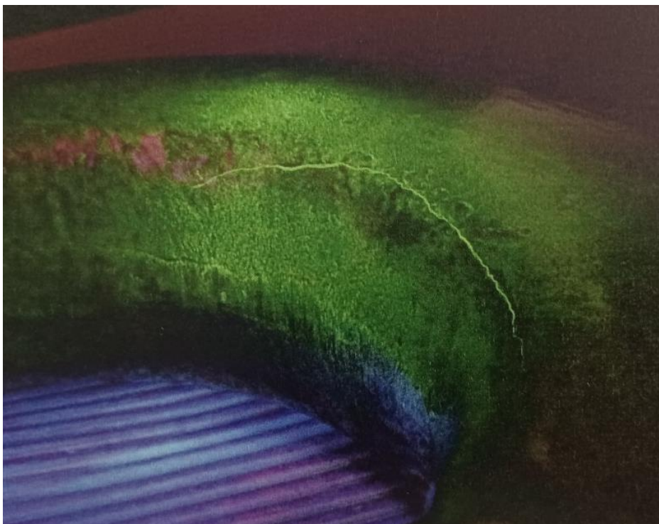
Slika 2.11. Magnetska indikacija otkrivena fluorescentnom tehnikom [17]
