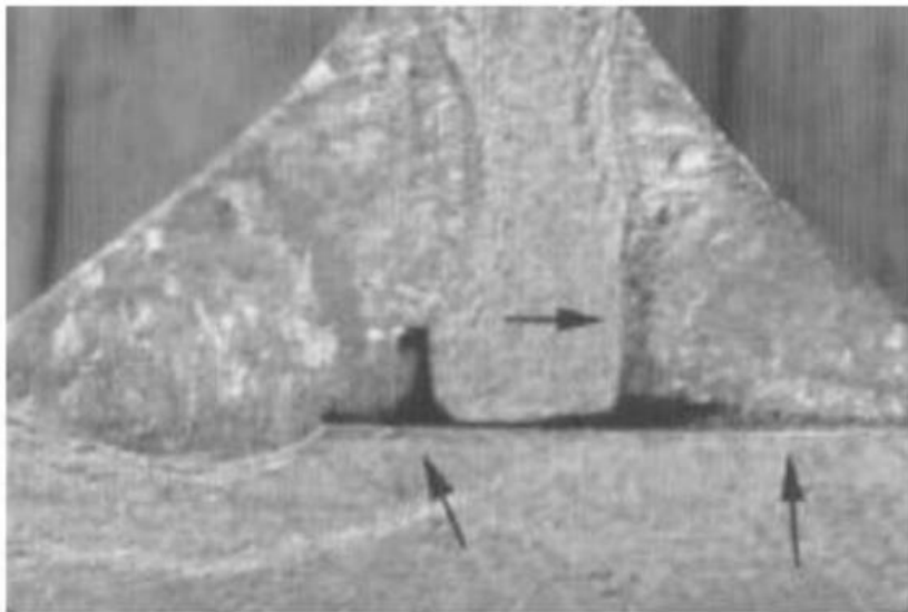
Slika 3.10. Naljepljivanje u kutnom spoju [29]
