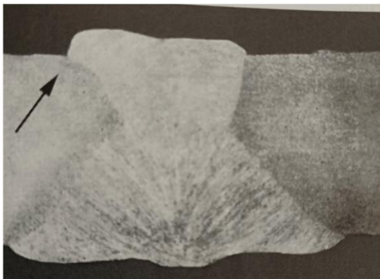
Slika 3.13. Pogreške oblika zavora – oštar prijelaz i preklop [29]
