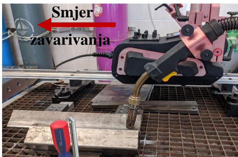
Slika 6.8 Namještanje automata za zavarivanje u PA položaju
