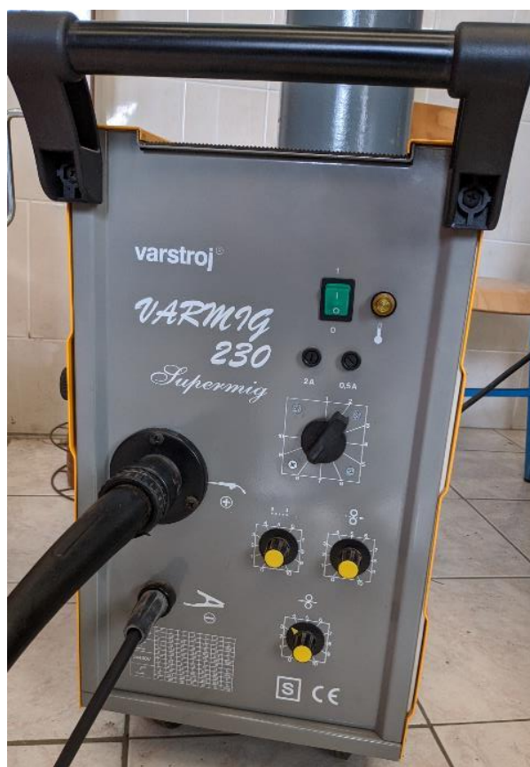
Slika 6.3 Varmig 230 Supermig izvor struje za zavarivanje
