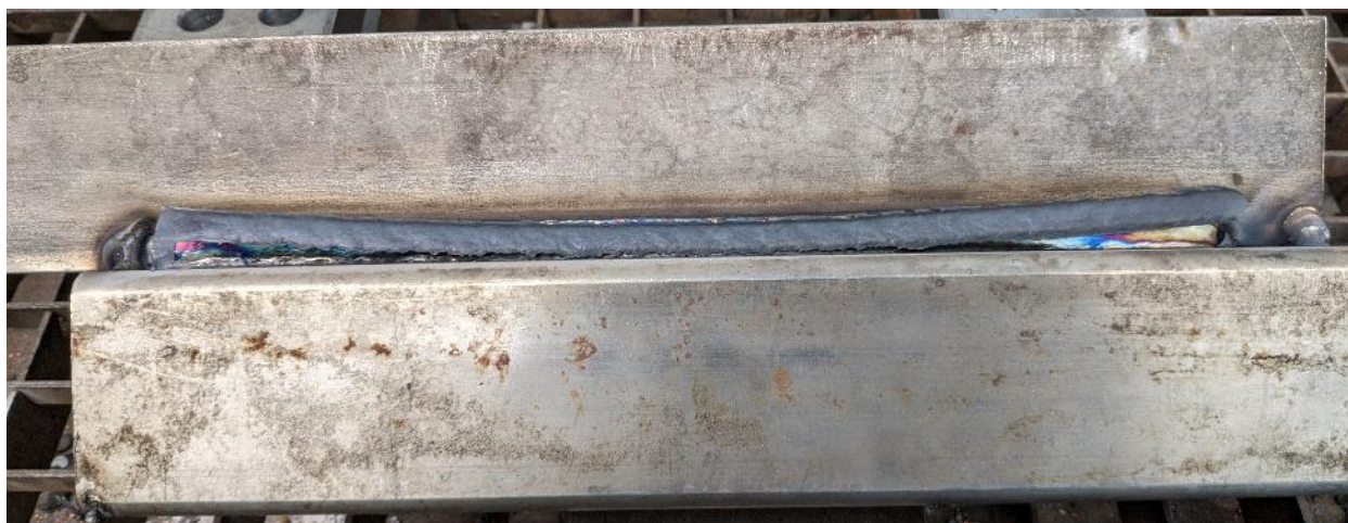
Slika 6.9 Odvojena troska nakon prvog zavara
