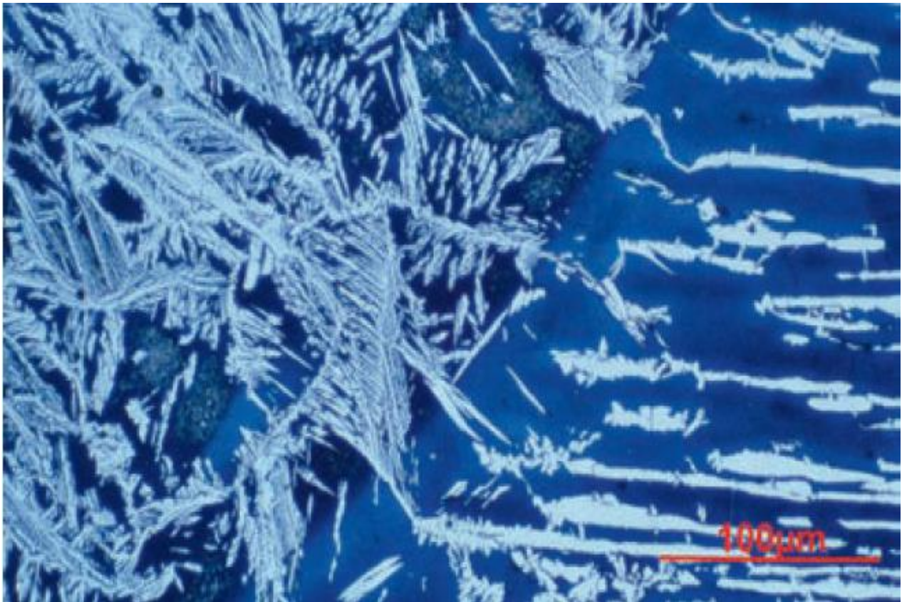
Slika 3.9 Mikrostruktura zavora dupleks čelika, osnovni metal desno, ZUT lijevo [12]
