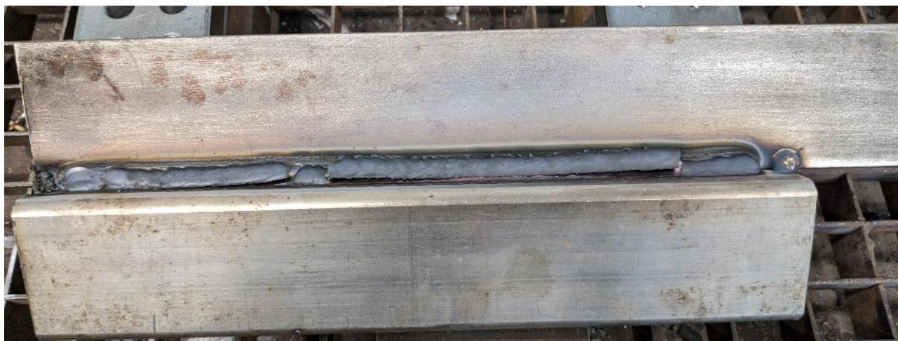
Slika 6.10 Odvojena troska nakon drugog zavara
