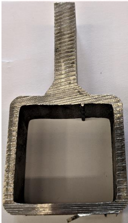
Slika 6.14 Izrezani ispitni uzorak
