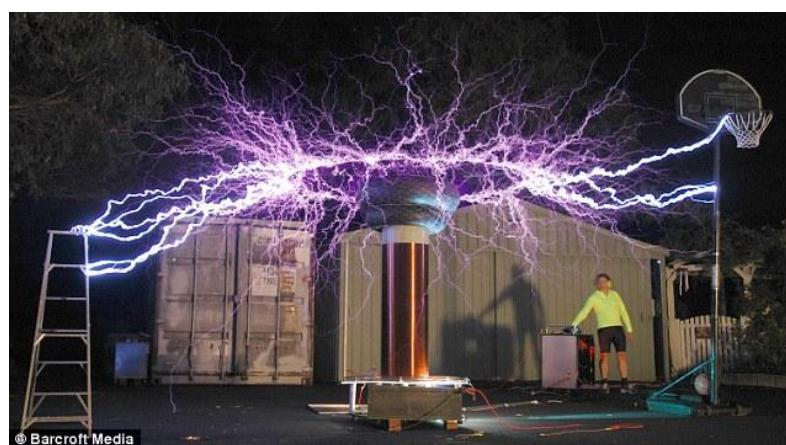
*Slika 3.4. VF Teslin transformator*
