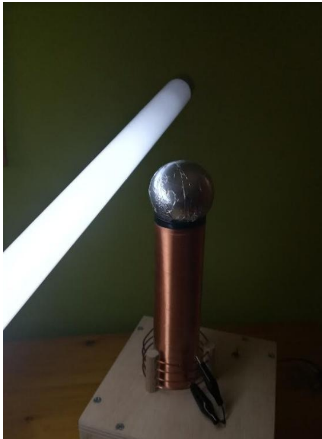
Slika 3.14. Širenje energije Teslinog transformatora
