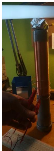
Slika 3.12. Probni rad pobuđivača napona na eksperimentalnoj pločici
