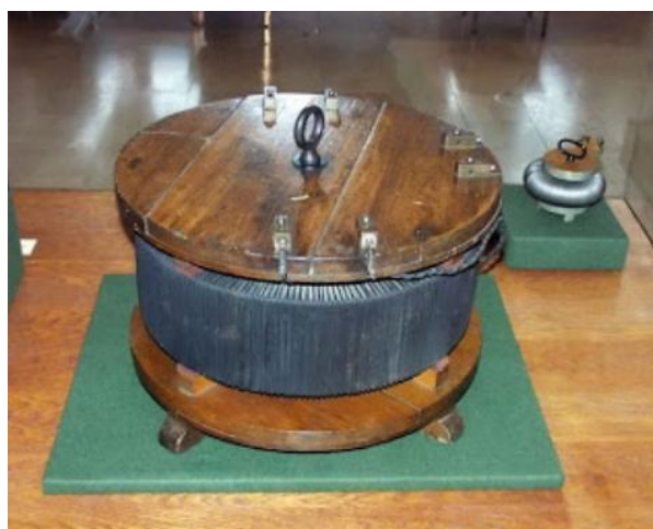
Slika 2.2. Prvi konstruirani transformator
