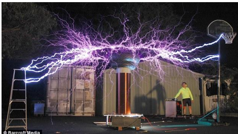
Slika 3.4. VF Teslin transformator
