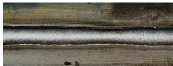
Slika 2.6 Premala brzina zavarivanja [15]
