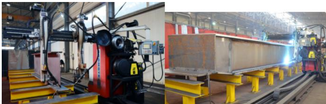
Slika 3.8 Primjena WA 1000/ WA 1500 automata za zavarivanje[35]
