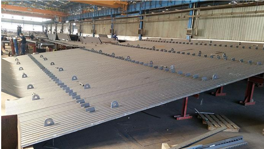
Slika 1.3 Membranski zid kotla za spalionicu otpada [4]
