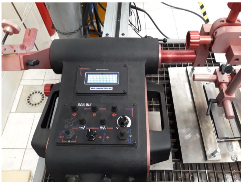
Slika 4.2 Automat za zavarivanje Rail Bull proizvođača Promotech, slikano u laboratoriju Sveučilišta Sjever u Varaždinu 07.04.2022.
