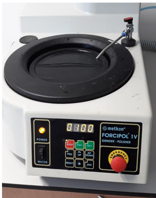
Slika 4.12 Uređaj za brušenje i poliranje Forcipol 1V proizvođača Metkon, slikano u laboratoriju Sveučilišta Sjever u Varaždinu 14.04.2022.
