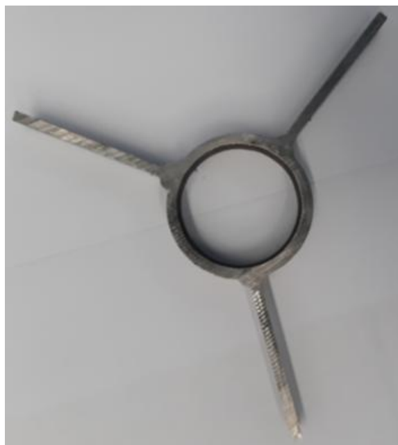
Slika 4.11 Izrezan uzorak za makroanalizu, slikano u laboratoriju Sveučilišta Sjever u Varaždinu 08.04.2022.
