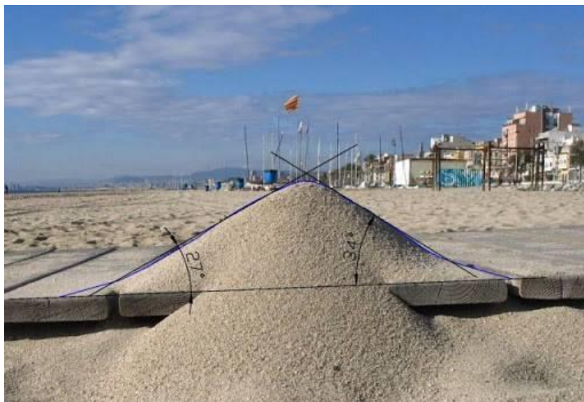
Slika 3.4.: Prikaz kuta unutarnjeg trenja
