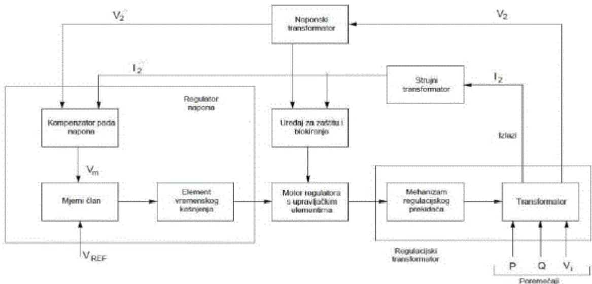
Slika 4.1 Blok-dijagram promjene omjera kod transformatora pod opterećenjem [15]
