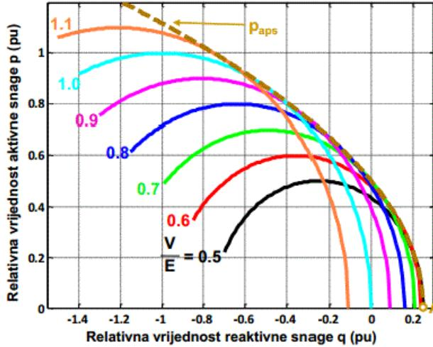
Slika 3.1 P-Q karakteristika prijenosnog sustava [11]
