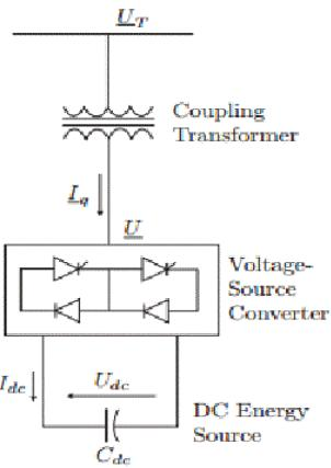
Slika 4.8 Shematski prikaz STATCOM-a [11]
