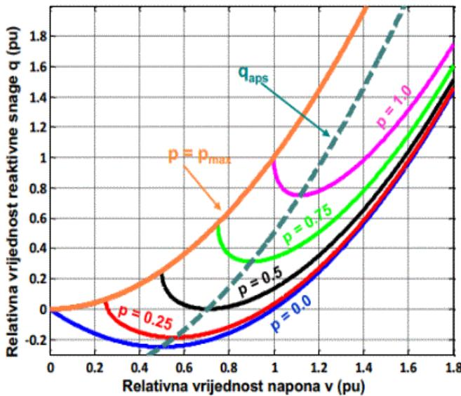
Slika 3.3 Q-V staticka karakteristika prijenosnog sustava [11]
