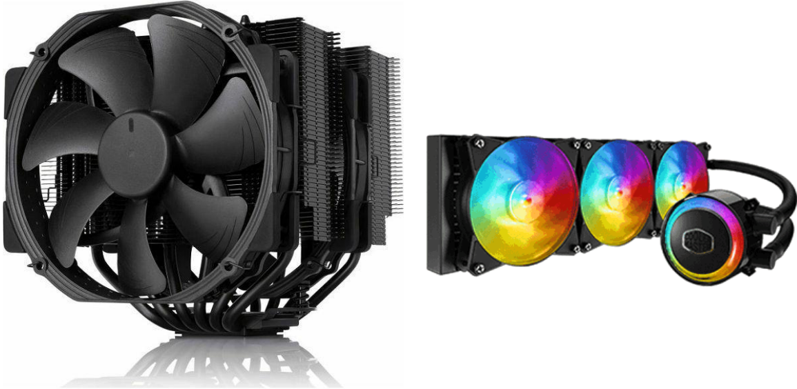
Slika 4.13 Prikaz zračnog hladnjaka i vodenog [46], [47]
