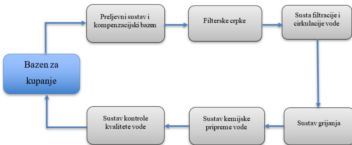
Slika 3.3 Tijek sustava za pripremu vode (vlastiti izvor)
