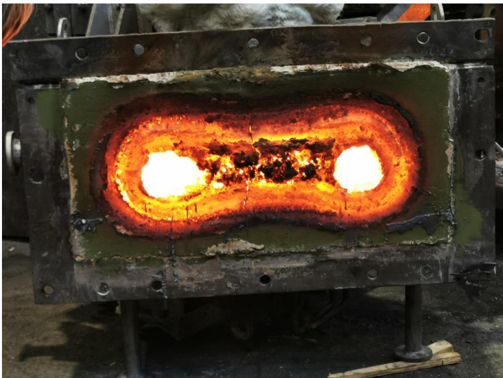
Slika 5.7 Presjek induktora [8]
