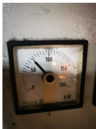
Slika 5.1. Mjerač snage kod normalnog režima rada [8]
