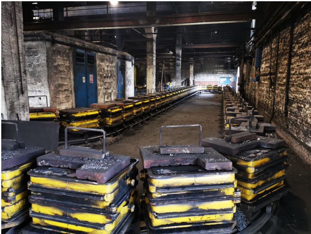
Slika 3.3 Linija hlađenja odljevaka prije istresanja [8]
