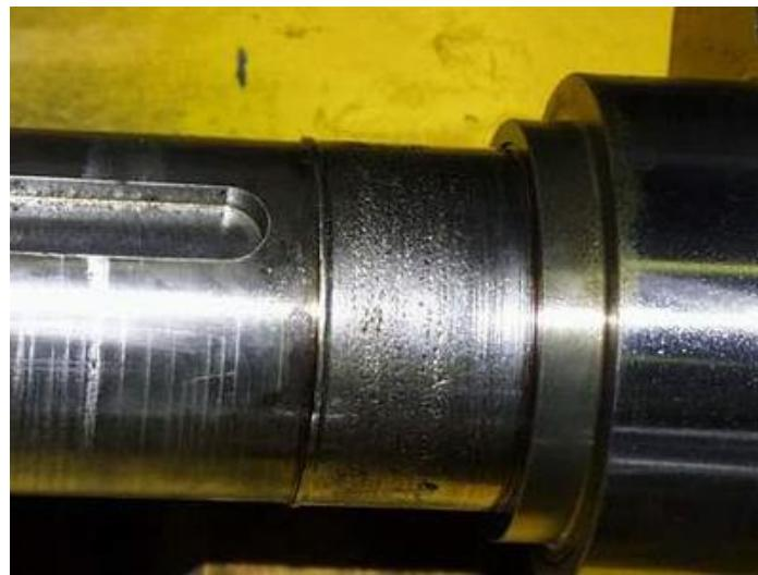
Slika 2.5 Oštećenje ležajnjog mjesta uzrokovano trošenjem [8]
