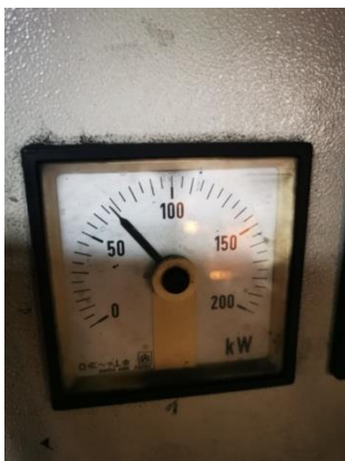
Slika 5.1. Mjerač snage kod normalnog režima rada [8]
