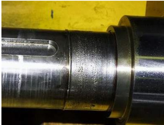
Slika 2.5 Oštećenje ležajnog mjesta uzrokovano trošenjem [8]
