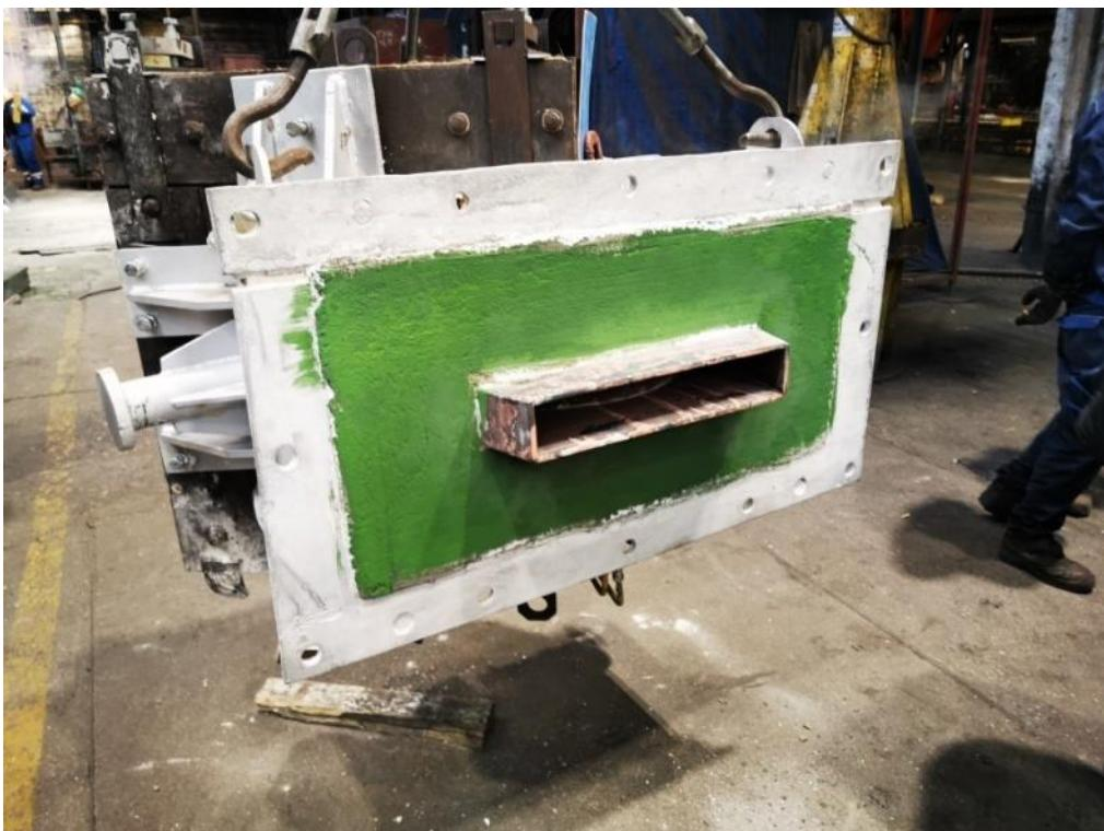
Slika 5.9 Premaz na induktoru [8]
