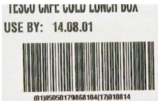
Slika 4-7 Primjer neadekvatnog razmaka između linija
