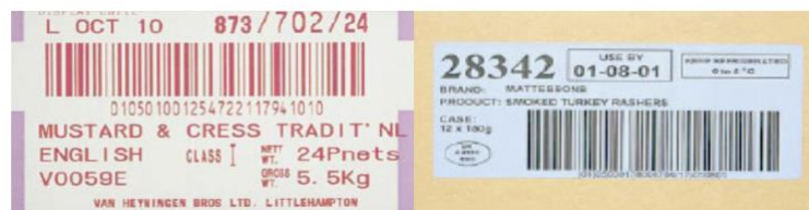
Slika 4-5 Prikaz izbljedjele naljepnice i/ili neadekvatne boje podloge (smanjeni kontrast)
