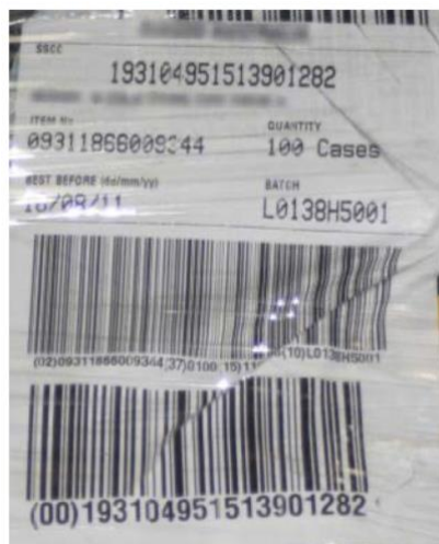
Slika 4-10 Primjer zgužvane naljepnice koja nije čitljiva
