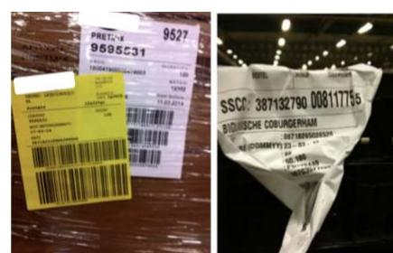
Slika 4-9 Primjer preljepljene ili oštećene logističke naljepnice
