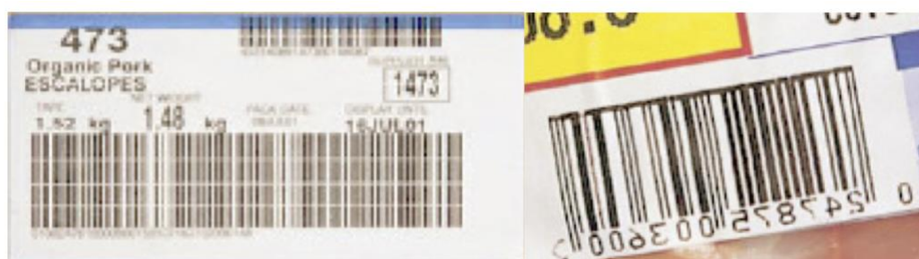
Slika 4-4 Prikaz lošeg ispisa barkoda i pojave neželjenih praznina ili (crnih) linija
