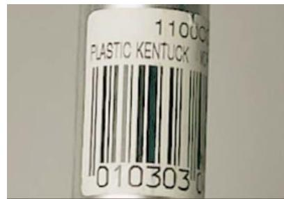
Slika 4-8 Prikaz pogrešno apliciranog barkoda na zaobljenoj površini
