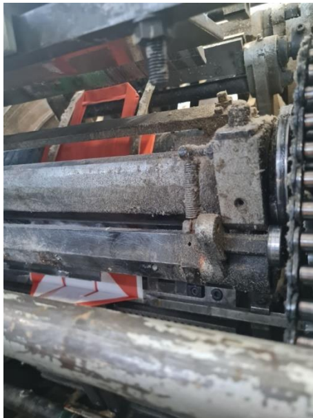
Slika 9.14. Primarno preklapanje dna pomoću dvaju noževa.
