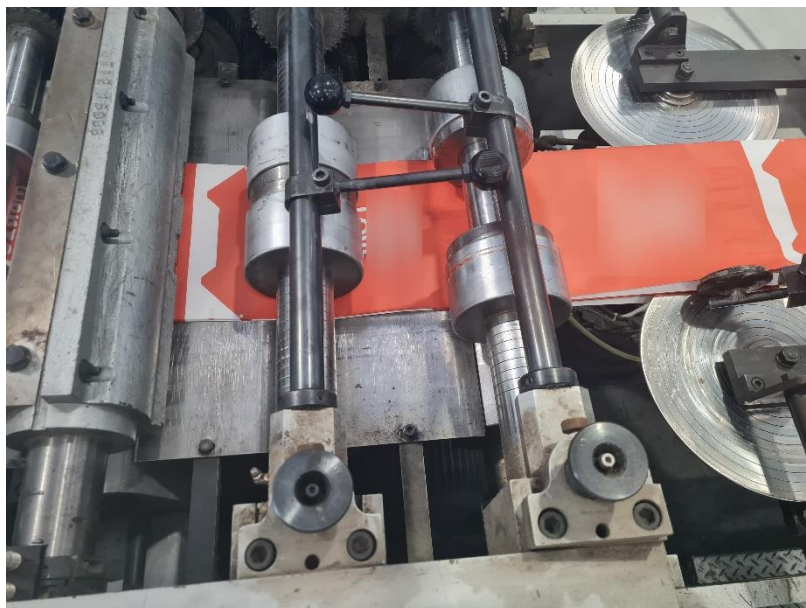
Slika 9.8. Sljepljivanje gornjeg dijela vrećice sa donjim pomoću longitudinalnog ljepliva na vučnim valjcima prije rezanja tijela
