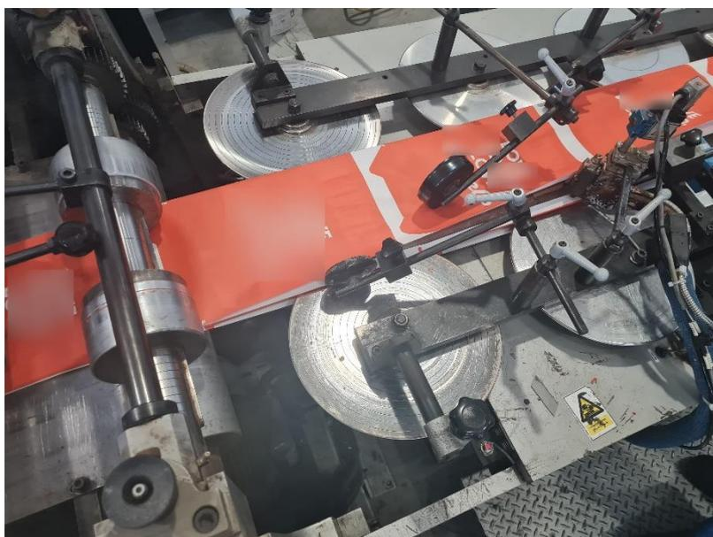
Slika 9.6. Formiranje falde, lijepljenje donje strane vrećice longitudinalnim ljeplom.
