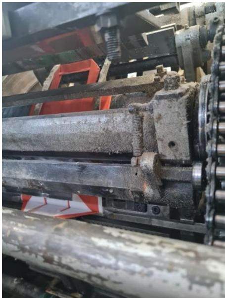
Slika 9.14. Primarno preklapanje dna pomoću dvaju noževa.
