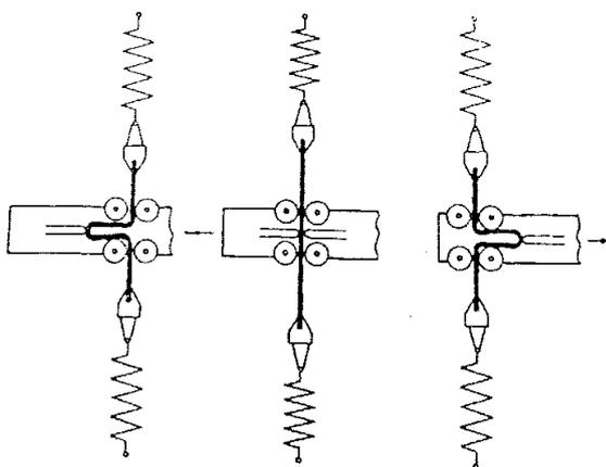
Slika 5.4. Određivanje broja dvostrukih savijanja
