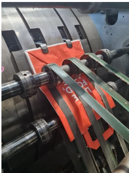
Slika 9.17. Prihvaćanje gotove vrećice na prihvatni bubanj
