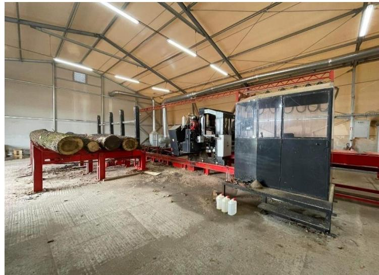
*Slika 11. Rampa sa trupcima i pokretna pila*
