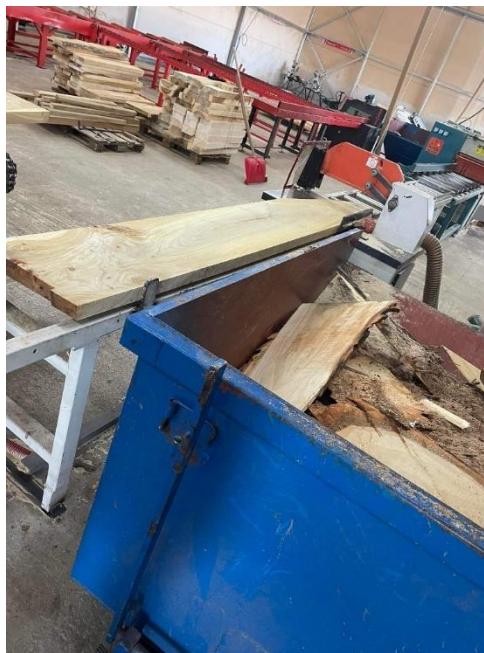
Slika 12. Štucer za rezanje daski i kontejner za drvni otpad
