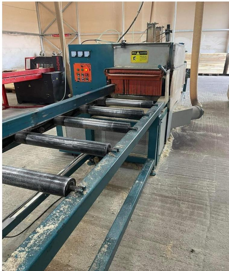
*Slika 13. Više lisna pila za daske i lege*
