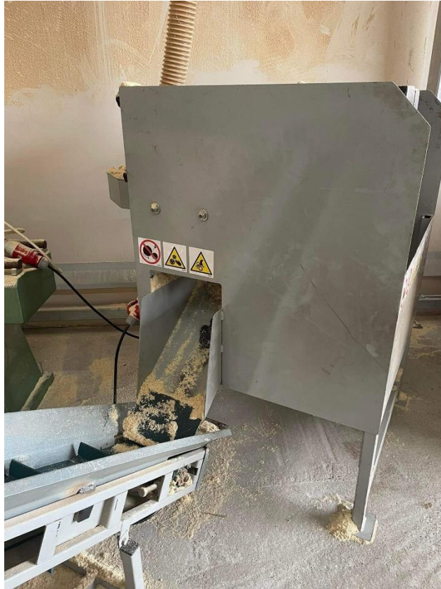
Slika 16. Uređaj za rezanje kocki
