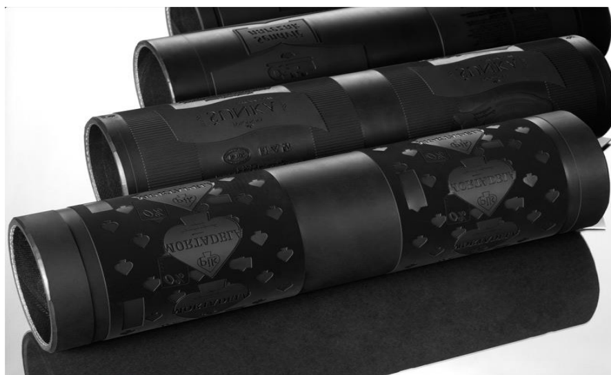
Slika 5.4 Gumena tiskarska ploča montirana na temeljni cilindar
