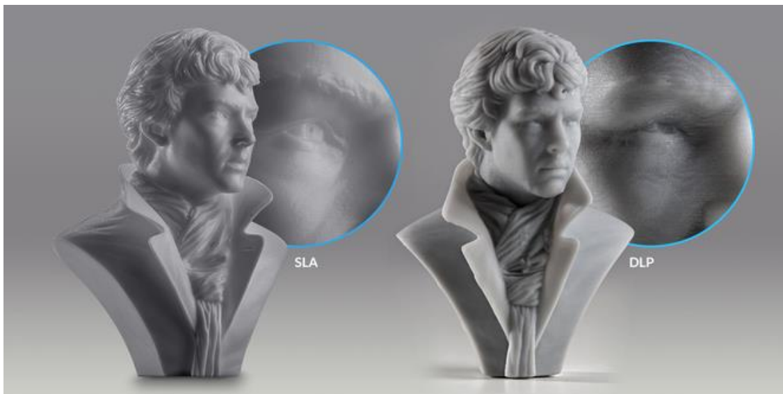
Slika 13 Primjer razlike između SLA i DLP načina ispisa
