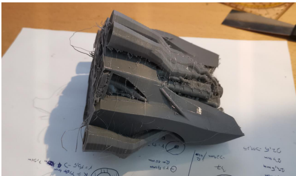
Slika 61 Prikaz stražnje strane automobila nakon 3D ispisa u sivom PETG materijalu
