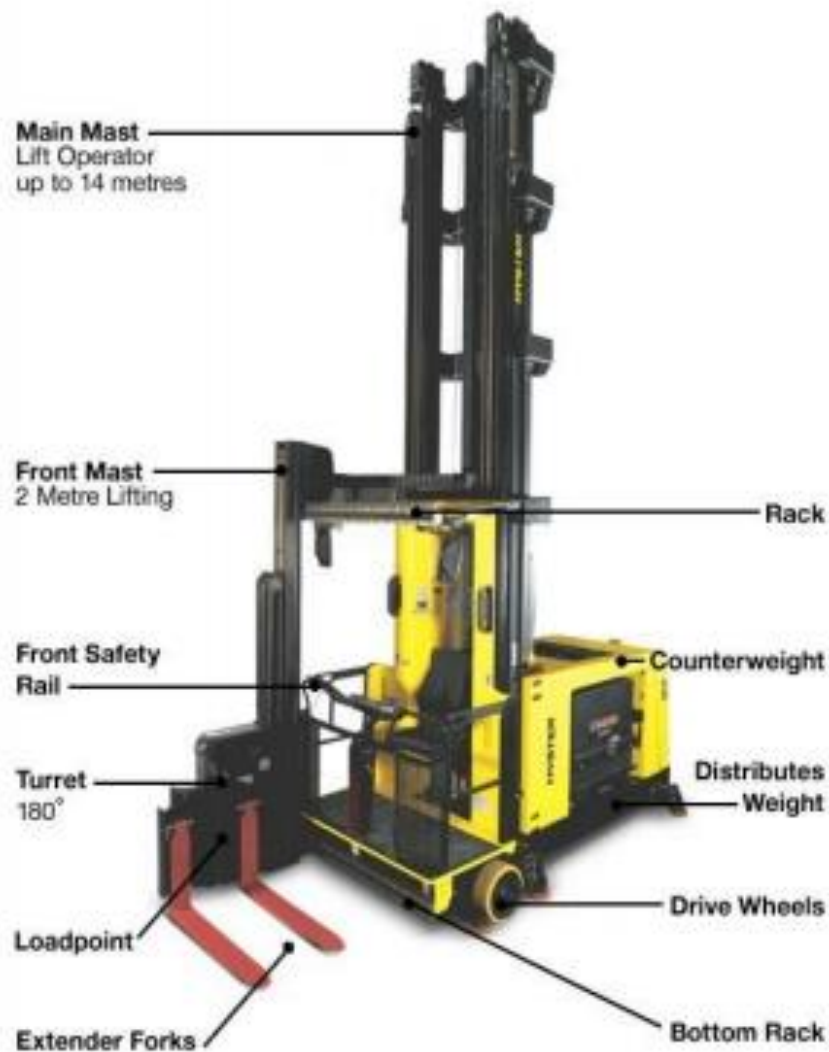
Slika 3.1.: Viličar sa zakretnim vilicama i njegovi dijelovi [24]
