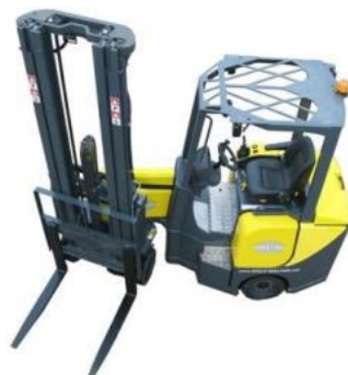
Slika 3.4.: Viličar sa okretnom prednjom osovinom [22]
