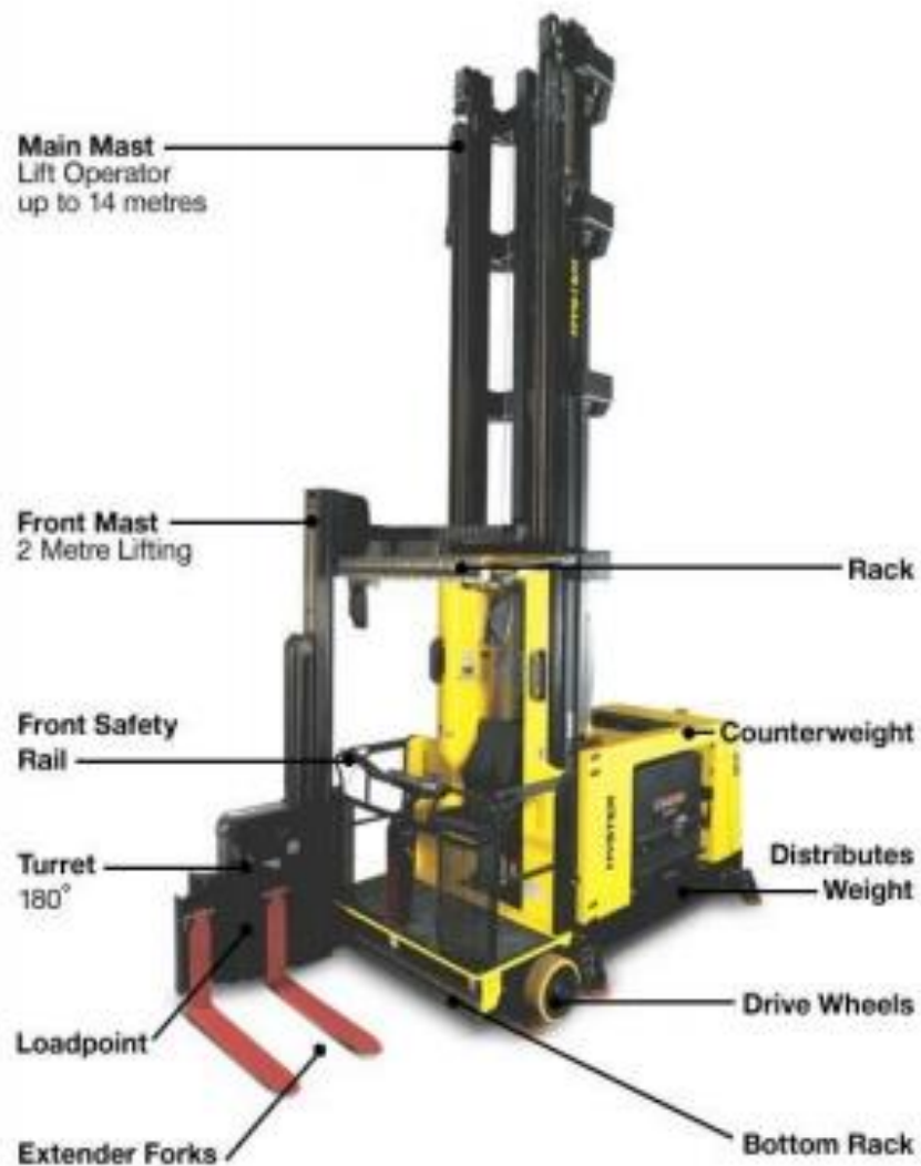
Slika 3.1.: Viličar sa zakretnim vilicama i njegovi dijelovi [24]
