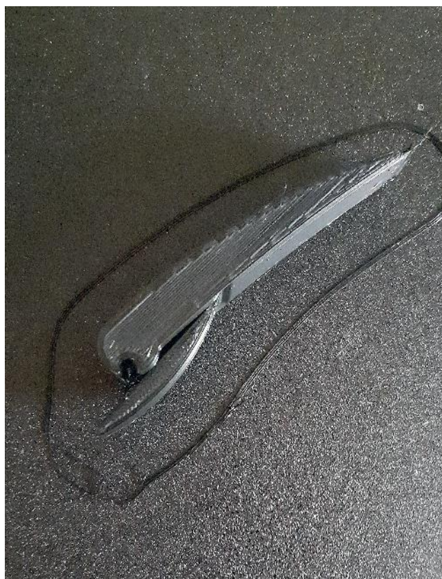
Slika 7.19 3D ispisani vršni dio luka
