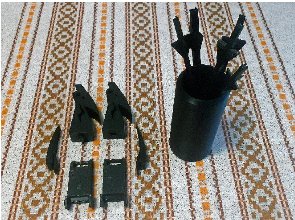
Slika 7.22 Svi 3D ispisani dijelovi opreme za streljaštvo
