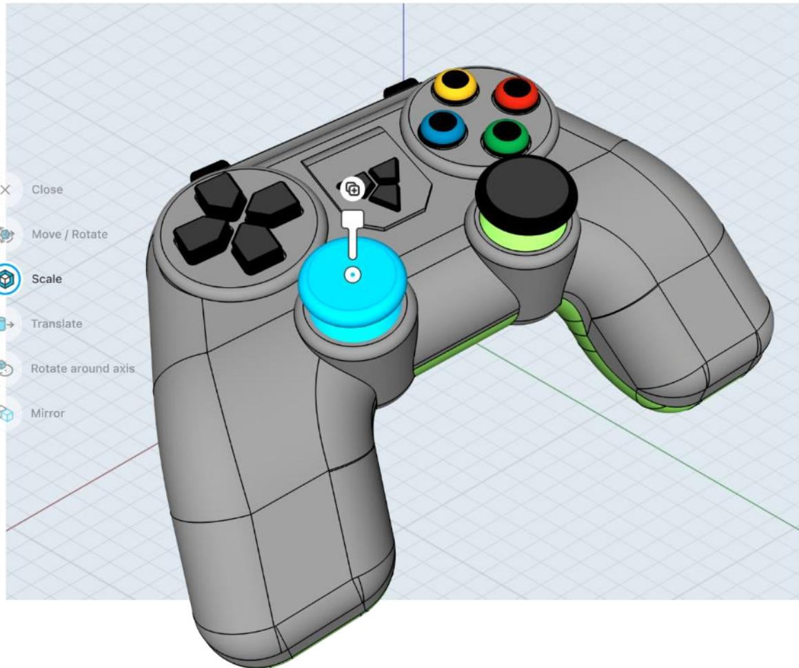
*Slika 3.2.6 Primjer korištenja Shapr3Da za izradu prototipa proizvoda*
