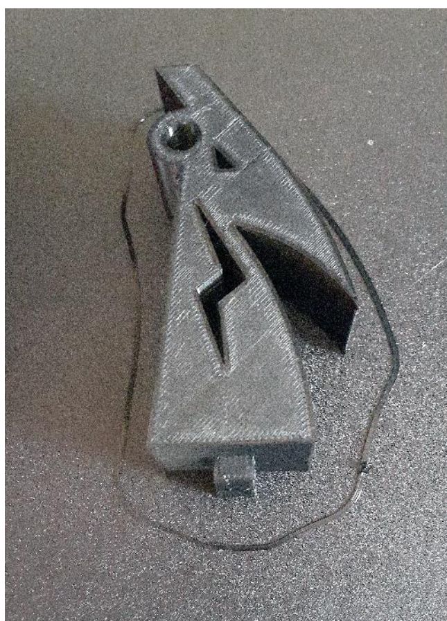
Slika 7.17 3D ispisani bazni dio luka
