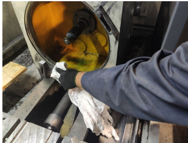
Slika 79 Čišćenje površina za prstene ili površina na prstenu
