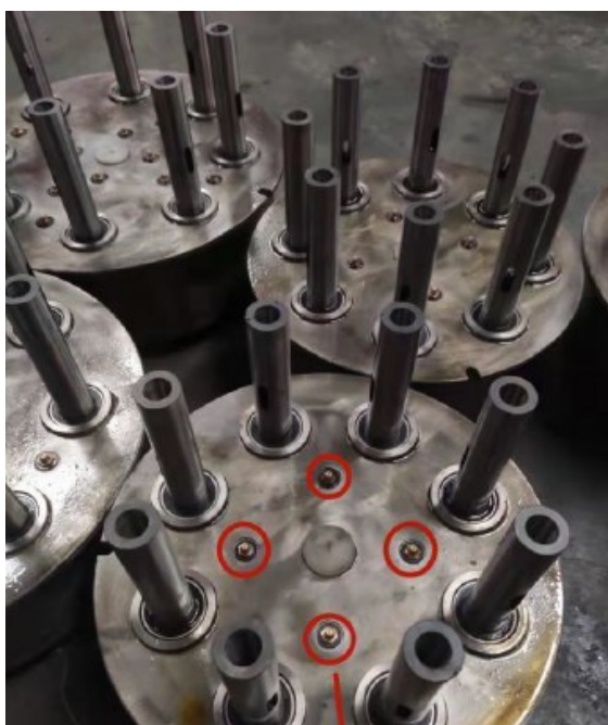
Slika 26 Podmazivanje glave za bušenje [10]
