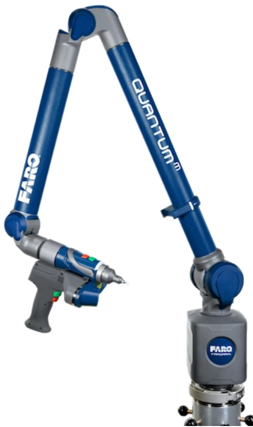
Slika 28 Faro Quantum M [11]
