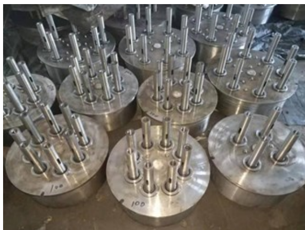
Slika 16 Glava za bušenje [10]
