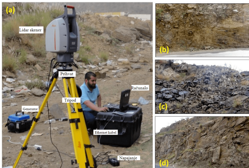
Slika 6: Komercijalni LIDAR skener u primjeni skeniranja odrona stijena [8]
